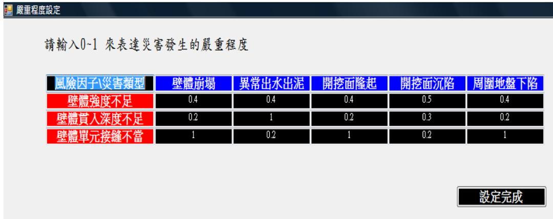
圖 4-5 連續壁作業災害嚴重程度設定圖
