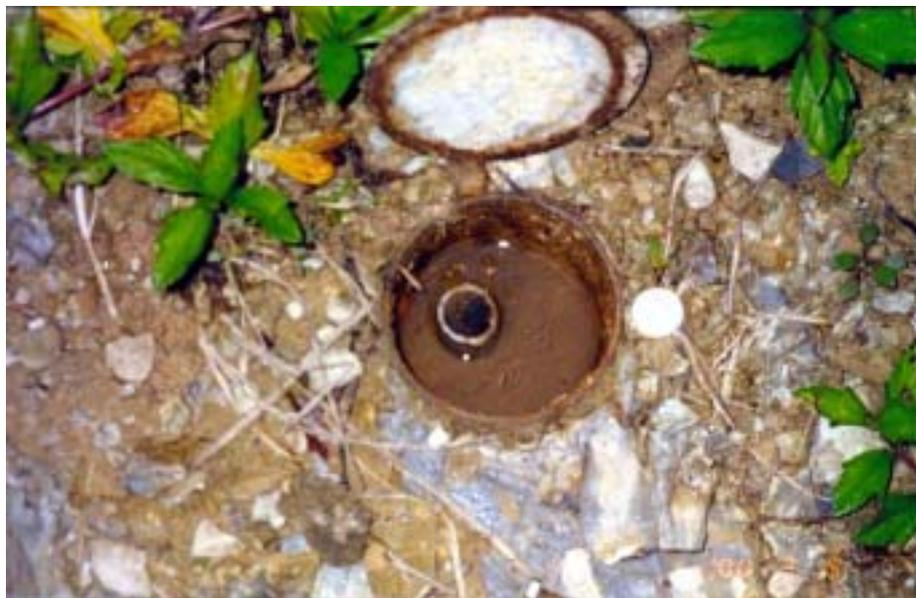
圖 6.4 案例 A-1 社區埋設的傾斜觀測管
