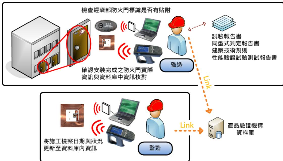
圖 3-9 防火門安裝完成後施工查驗流程圖
