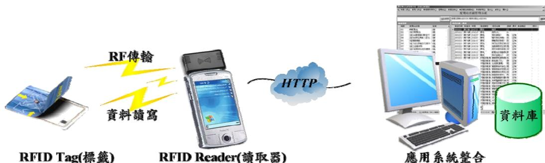
**圖 1-3 無線射頻識別 RFID 系統基本架構圖**
