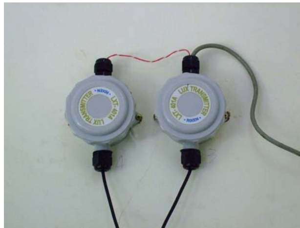
圖29 新裝設之照度感知器
