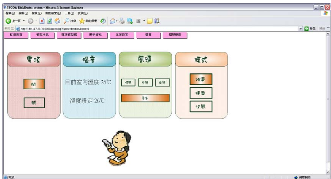
圖32 空調系統控制頁面，具備有空調室內機狀態監看、啟停控制等功能
