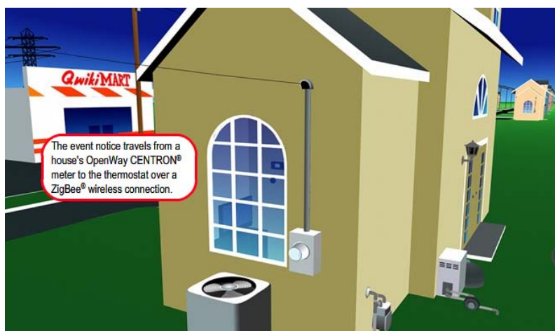
圖103 用戶之空調照明等用電設備接受此智慧電表之通訊訊息，及預設之調控模式(HEMS)。
