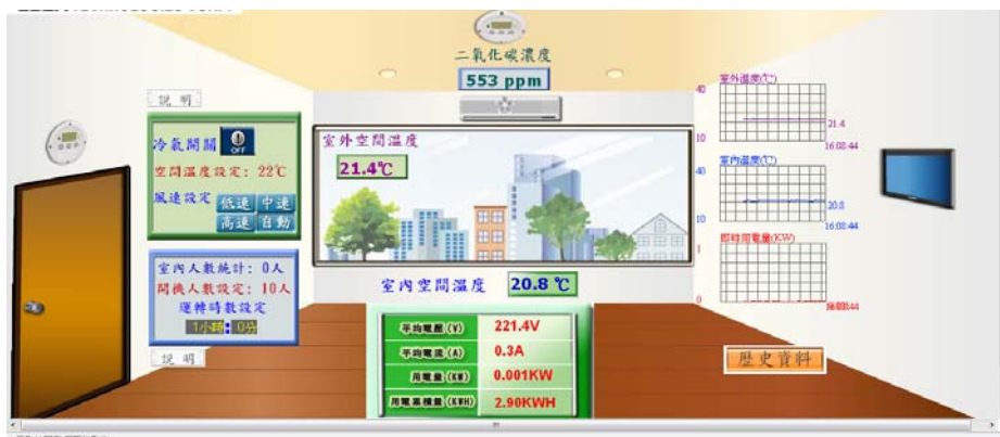
圖98 紅外線人感空調控制系統之監控頁面
