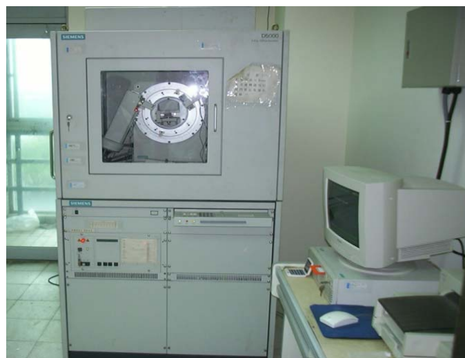
照片 3-22 X 光繞射分析儀
