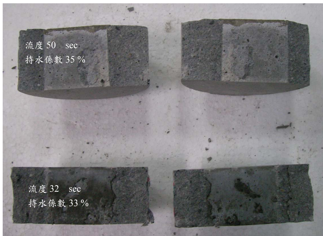
照片 4-1 流度 32、50 sec 劈裂截面
