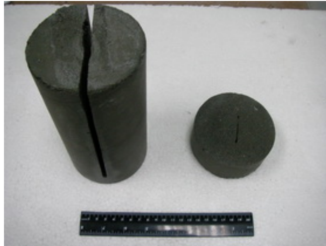
照片 3-9 預設，5 及 0.5 mm 寬度裂縫試體
