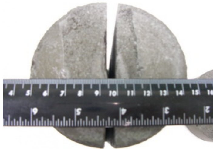
照片 3-11 5 mm 寬度裂縫
