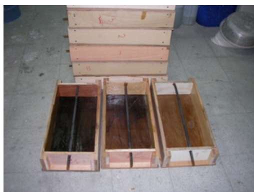
照片 3-12 鋼筋混凝土板模
