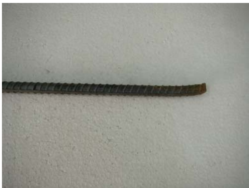
照片 3-7 #4 竹節鋼筋
