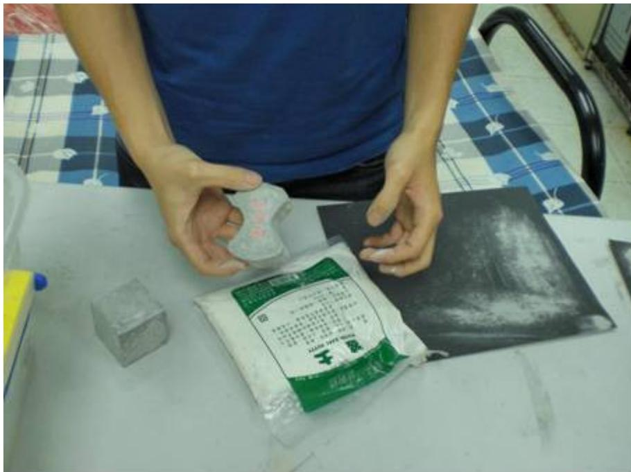
圖 3-3 試體塗裝前表面大孔隙以批土填補
