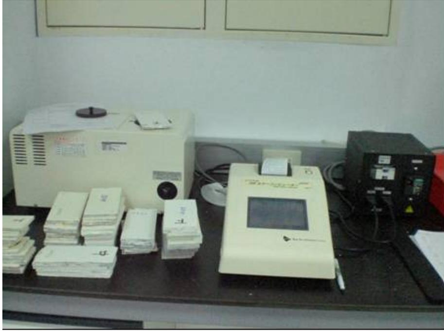
圖 3-17 塗料試片顏色差異量測設備
