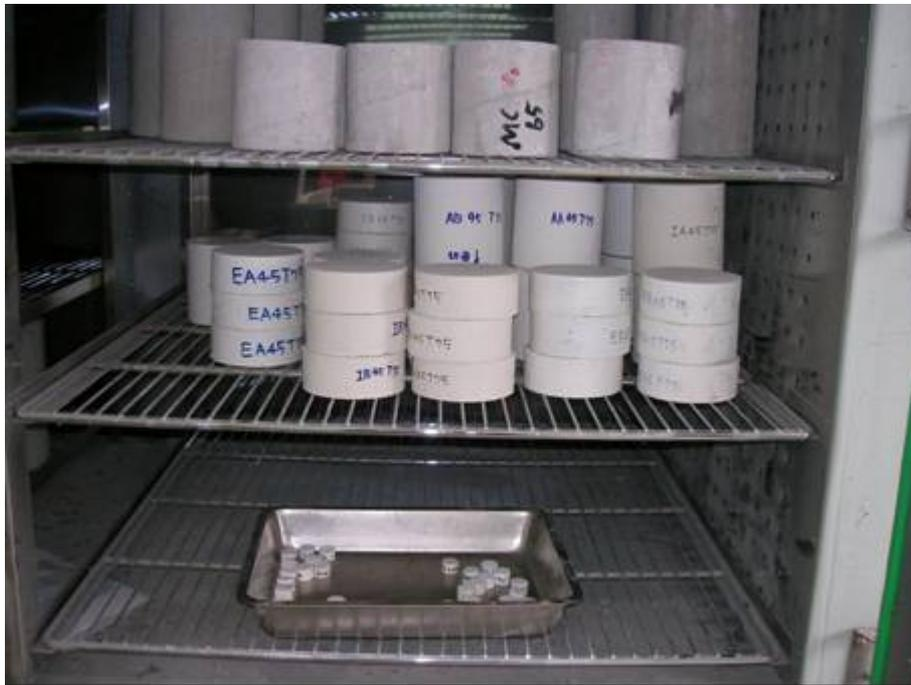
圖 3-9 本研究試體進行烘箱加速劣化情形
