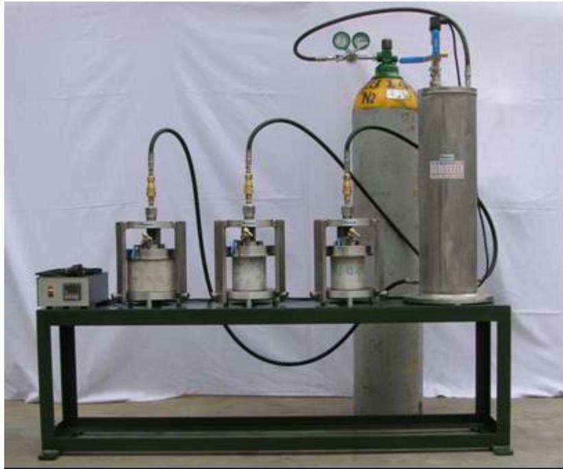
圖 3-15 透水試驗設備
