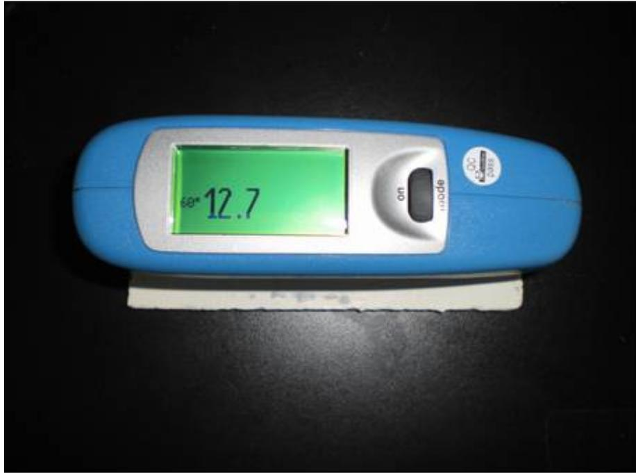
圖 3-18 塗料試片光澤度量測設備
