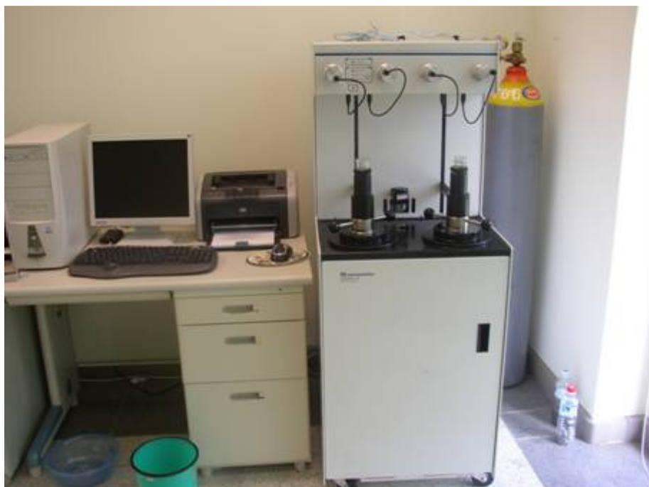
圖 3-14 Autopore 9500 壓汞孔隙儀
