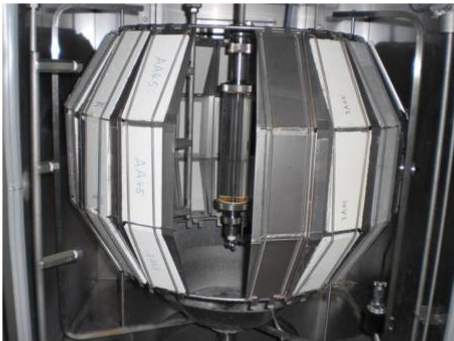
圖 3-11 試驗槽內之氙弧燈與試片迴轉框
