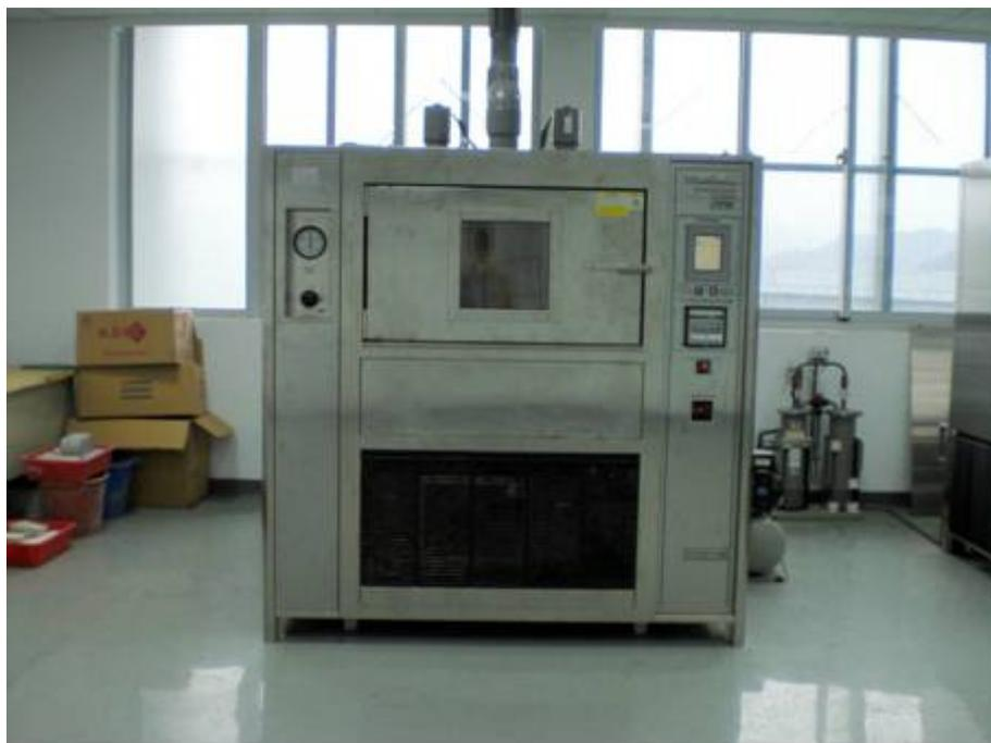
圖 3-10 CTP96 鹽霧複合耐候試驗機
