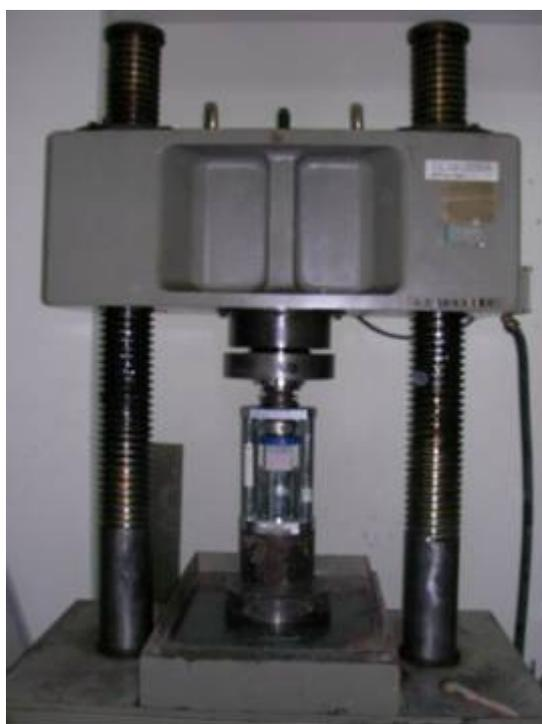
圖 3-12 水泥砂漿試體抗壓強度試驗
