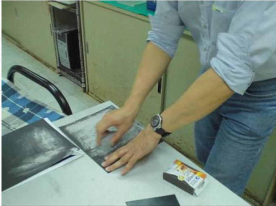
圖 3-2 試體表面以 200 號砂紙磨平之前處理過程
