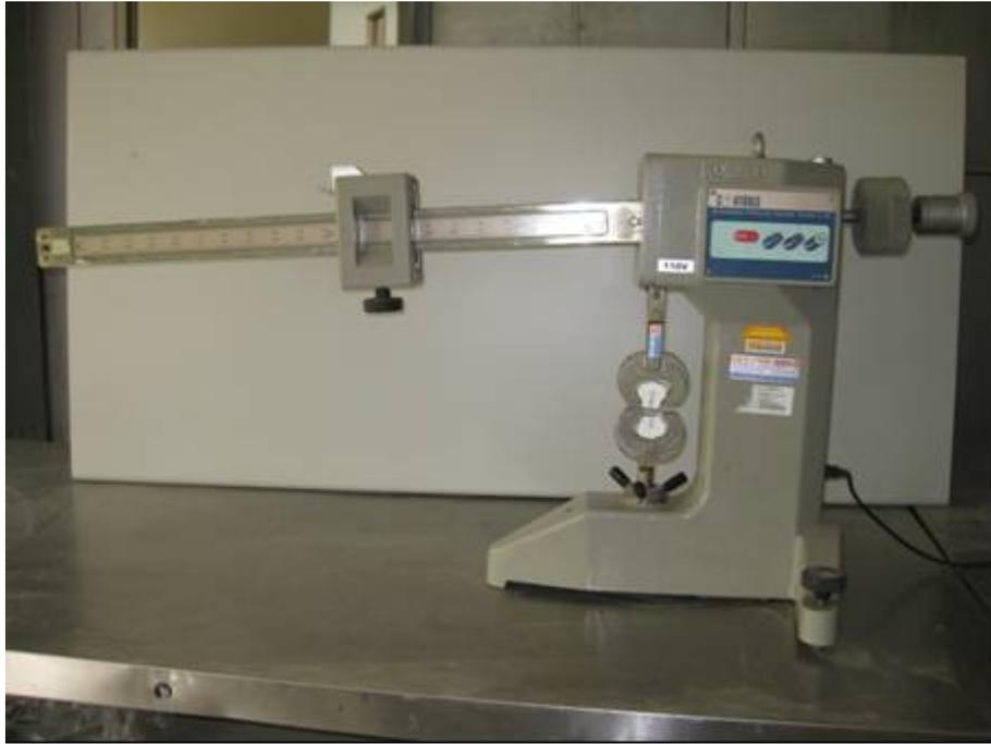
圖 3-13 水泥砂漿試體抗拉強度試驗
