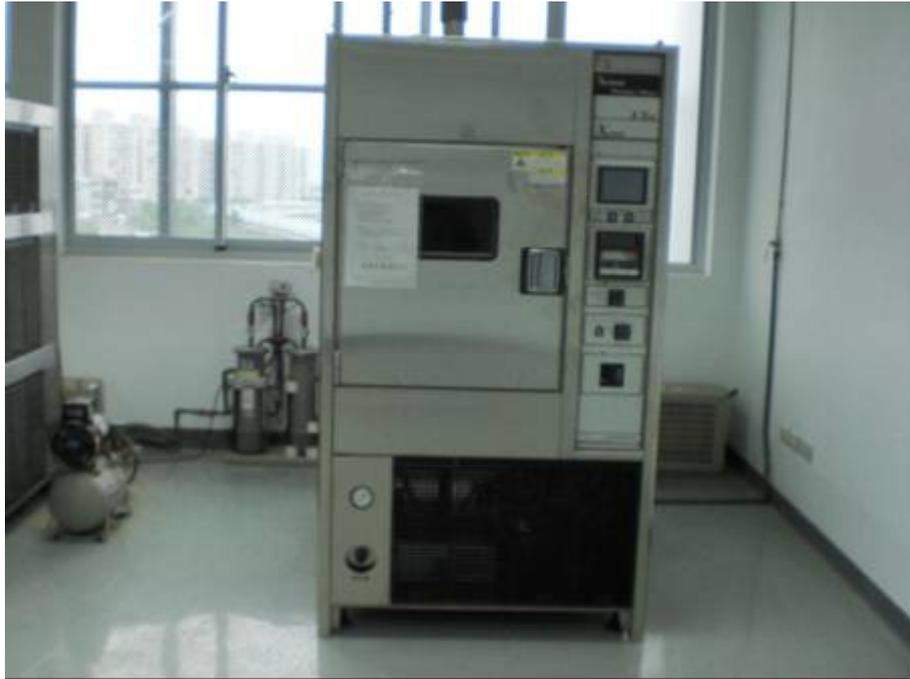
圖 3-10 SUGA X75 氙弧燈耐候試驗機外觀
