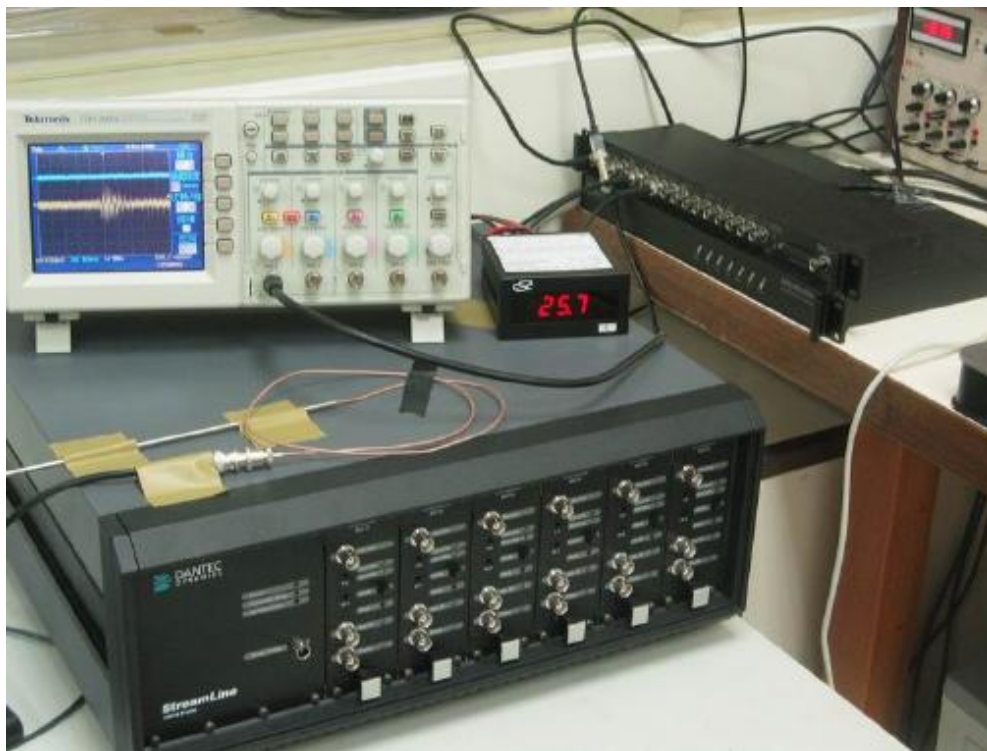
圖 5-16 熱線測速儀主機、示波器與資料擷取系統
