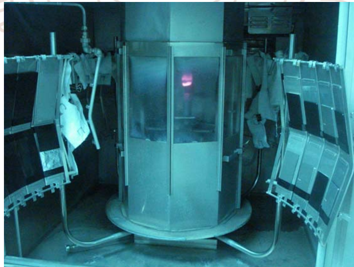
圖 4-5 碳弧燈管與試件配置圖
