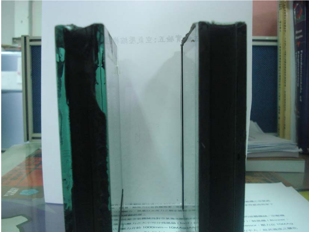
圖 4-16 結構膠密封與熱溶膠密封之試驗結果
