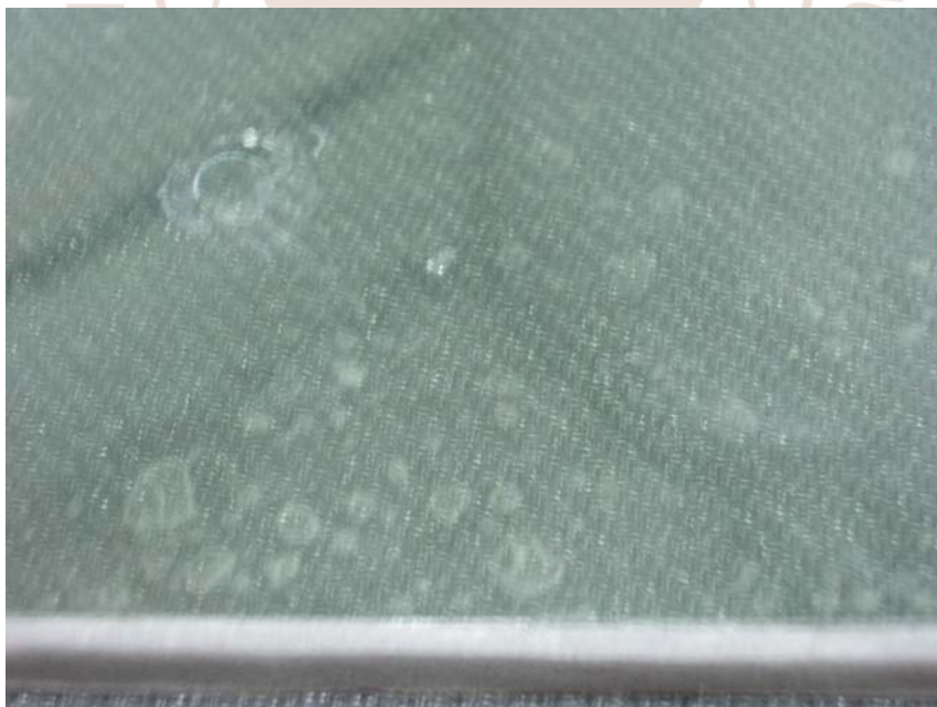
圖 3-3 中間夾隔熱膜之膠合玻璃受熱之質變
