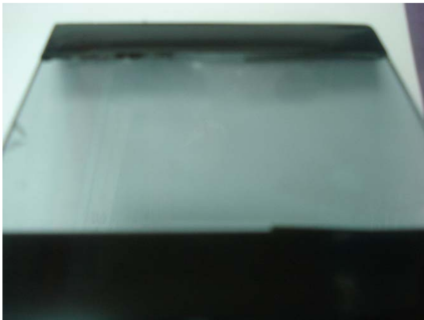
圖 4-10 6mm 貼附隔熱膜玻璃
