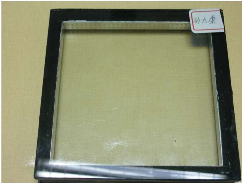
圖 3-2 複層玻璃 (使用矽力康密封膠)
