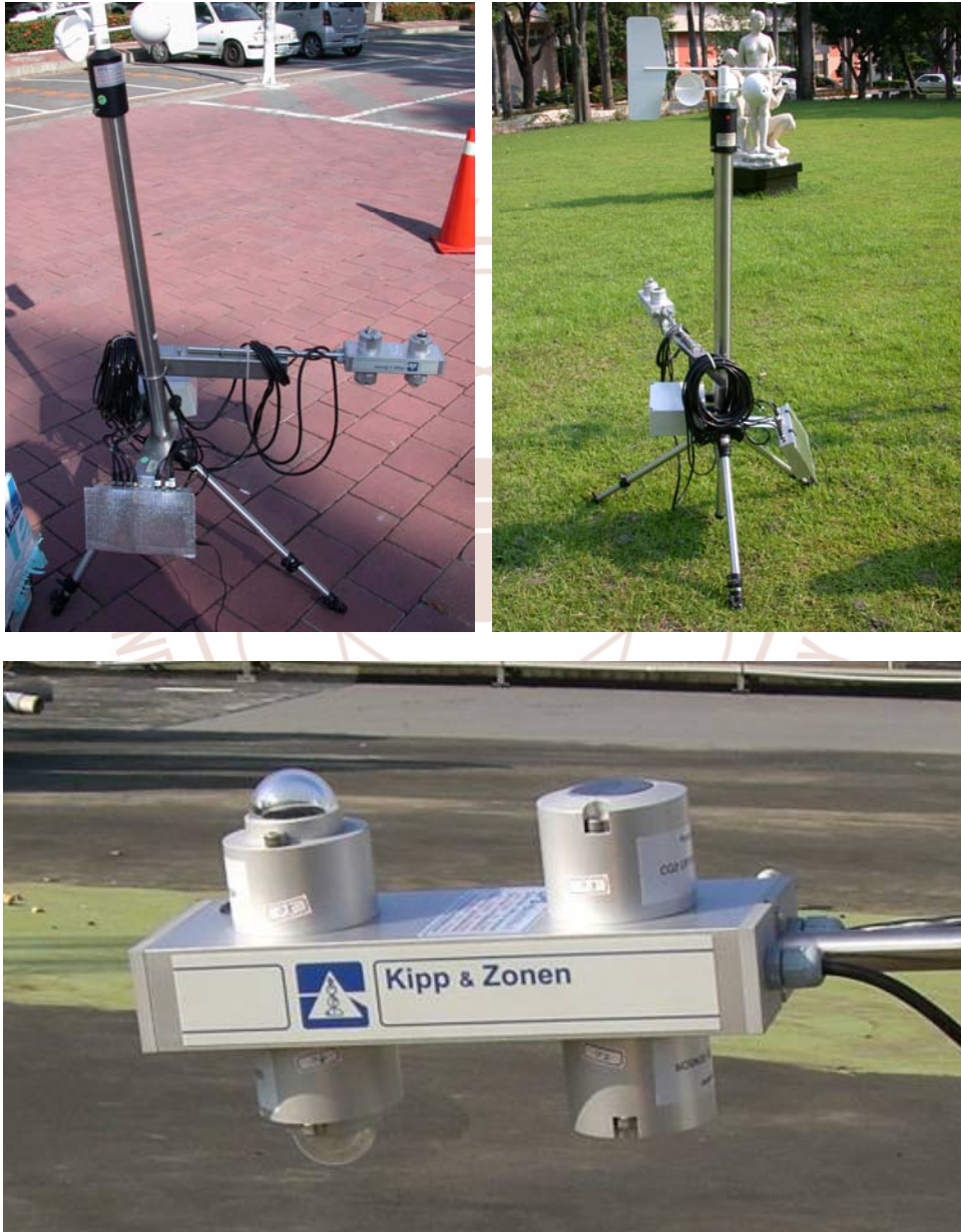
圖 5-9 研究團隊針對柏油、水泥、紅色連鎖磚、草地地面材料的「反照率」(Albedo)的初步測試性的實驗計畫
