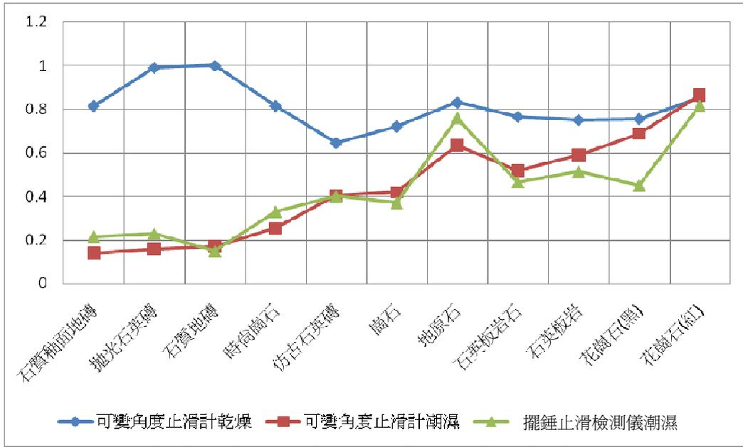
圖 4-1.1 不同材料可變角度止滑計與擺錘止滑檢測儀防滑係數值分布圖
