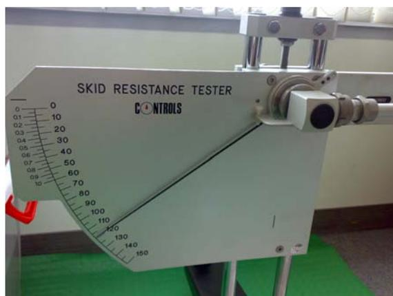
圖 3-2.2 本研究使用之擺錘止滑檢測儀
