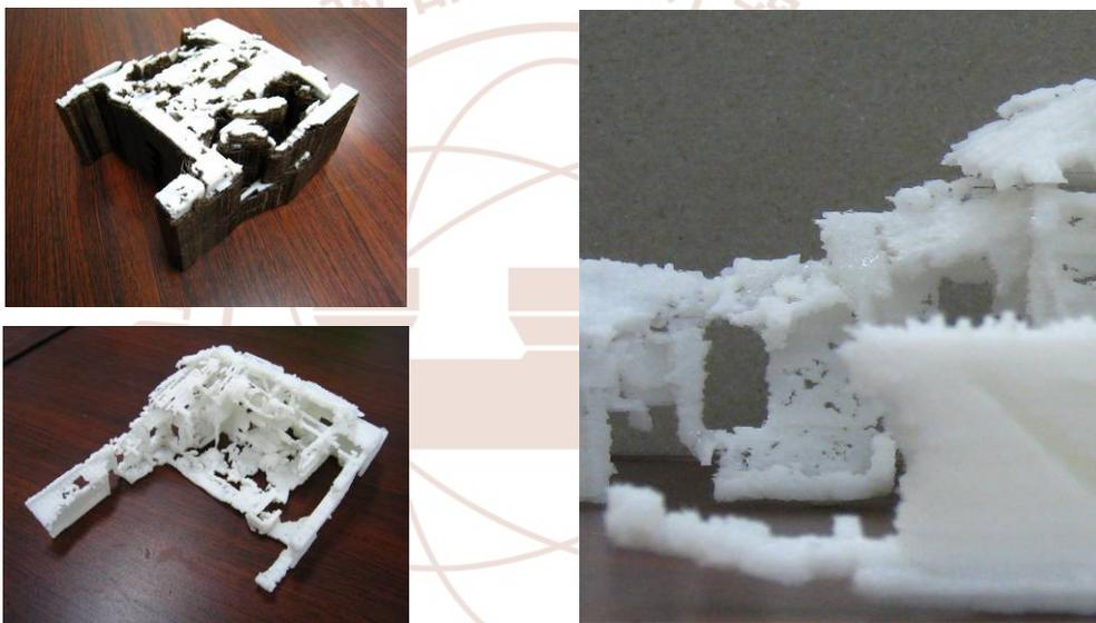
圖 5-34 齊東街 13 號日式宿舍實體模型輸出：支撐材未清洗(左上)支撐材已清洗(左下)細部呈現(右)
