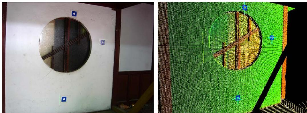
圖 4- 21 規標設置情況(左)及掃瞄中的規標資訊(右)
