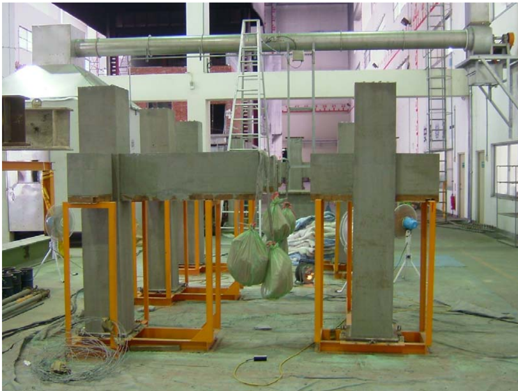
圖 3.25 梁柱試體拆模
