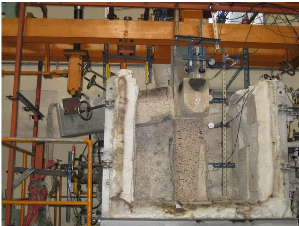
圖 4.55 (a) SCC5 殘餘極限承載試驗試體破壞照片 (1)
