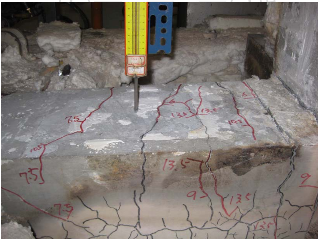
圖 4.54 SCC5 殘餘極限承載試驗試體裂縫發展情形
