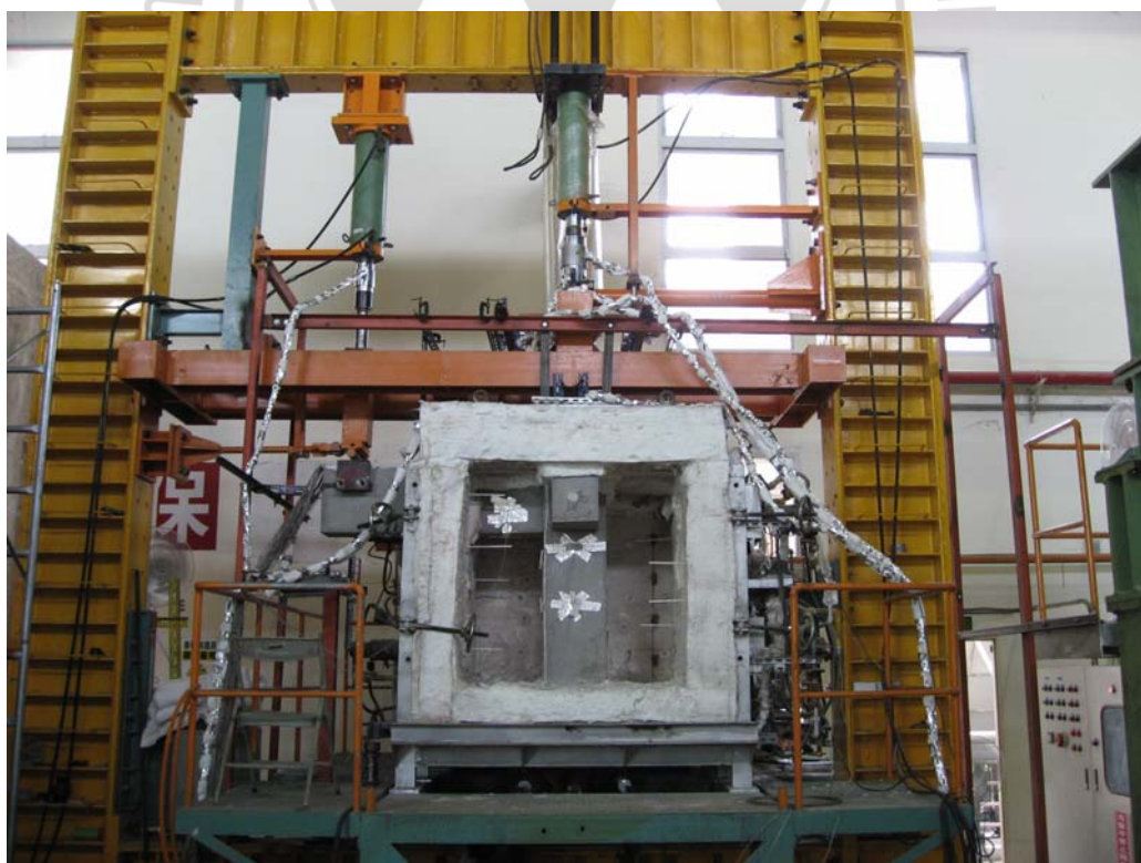
圖 3.30 高溫試驗試體安裝於耐火爐照片
