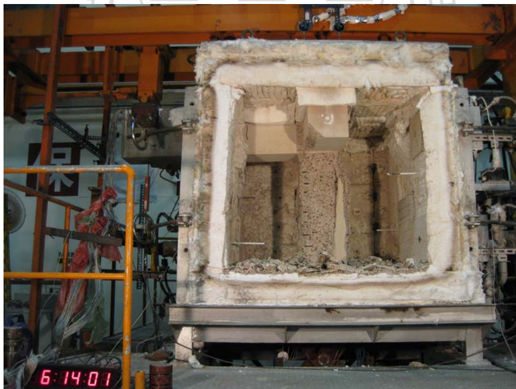
圖 4.36 SCC5 試體火害後照片
