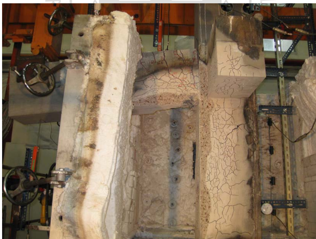
圖 4.53 (a) SCC3 殘餘極限承載試驗試體破壞照片 (1)
