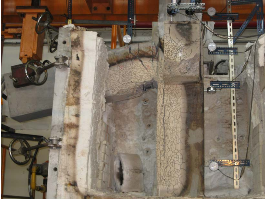
圖 4.51 (a) NC3 殘餘極限承載試驗試體破壞照片 (1)
