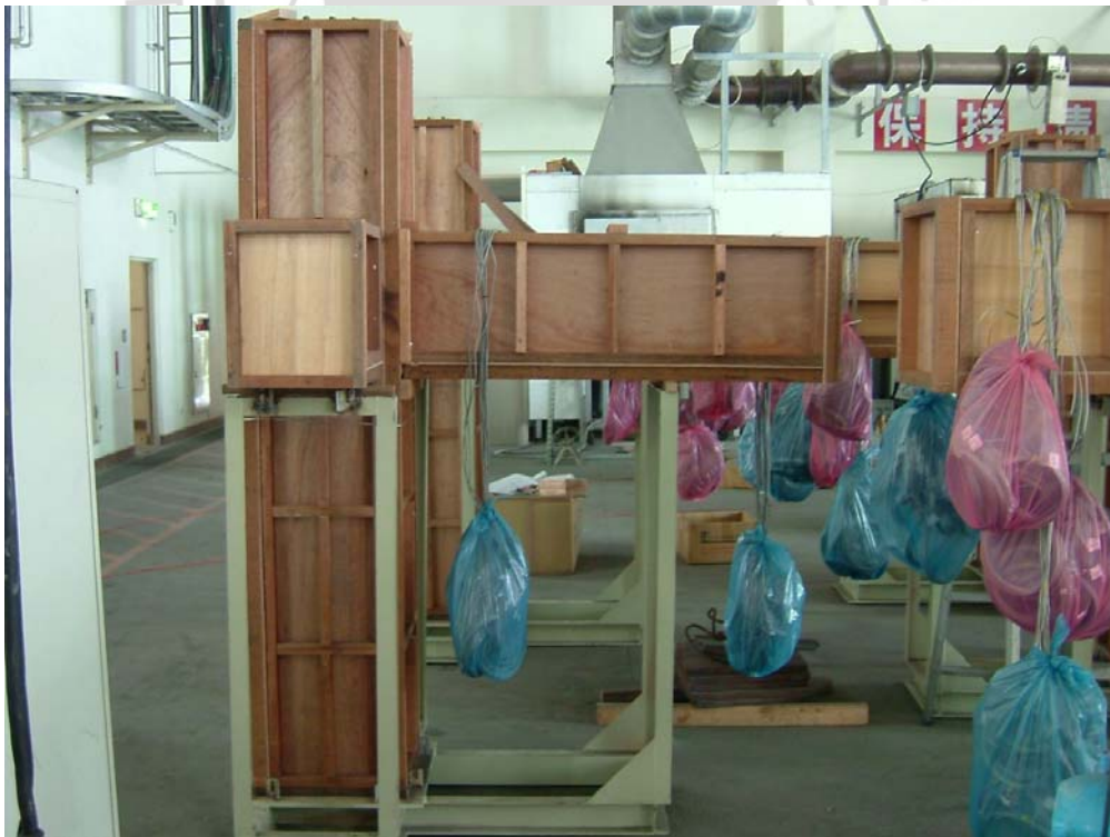
圖 3.24 模板組立照片
