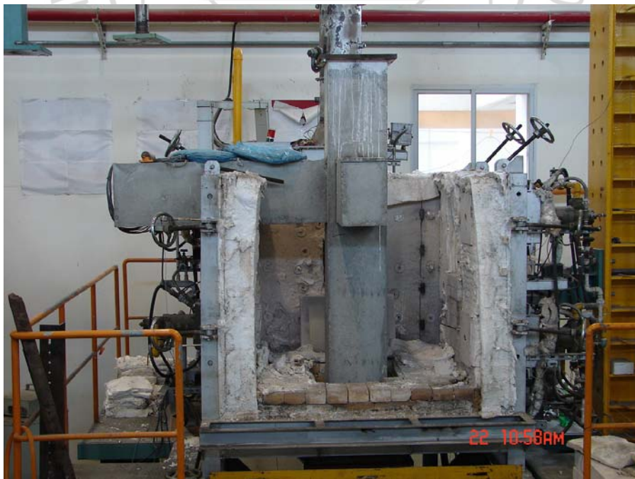
圖 3.28 常溫試驗試體安裝於耐火爐照片
