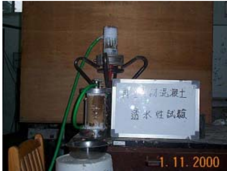
圖 4-7 透水試驗儀器架設
