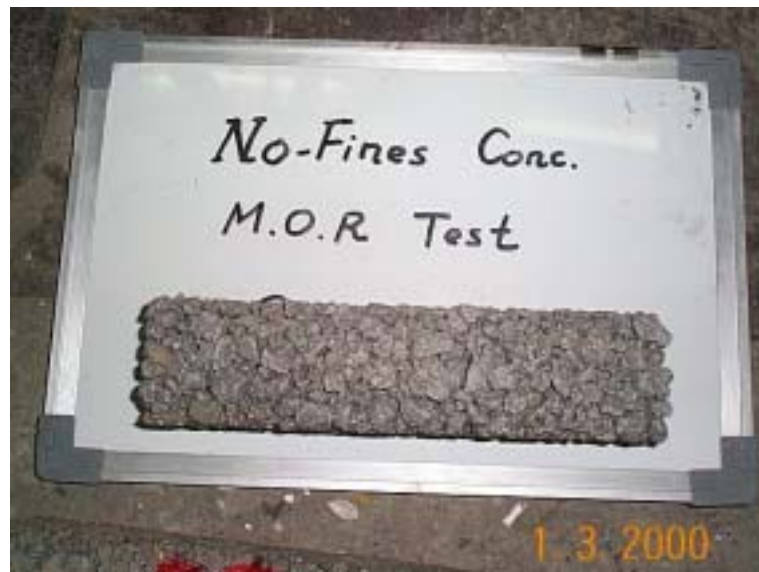
圖 4-3 抗彎試驗 ( MOR ) 用試體
