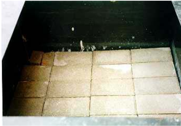
圖 5-5 無細骨材混凝土與面層鋪面磚之組合試體
