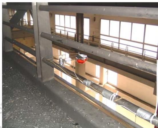
圖 6-23 差動式集中型熱探測器於實驗場地之實際佈置圖
