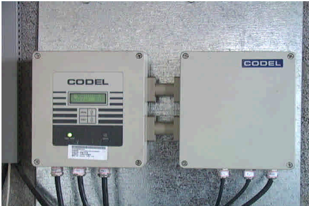
圖 2-6 煙遮蔽量測的訊號處理器(本研究)
