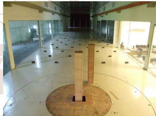
圖4-21 氣動力模型架設狀況
