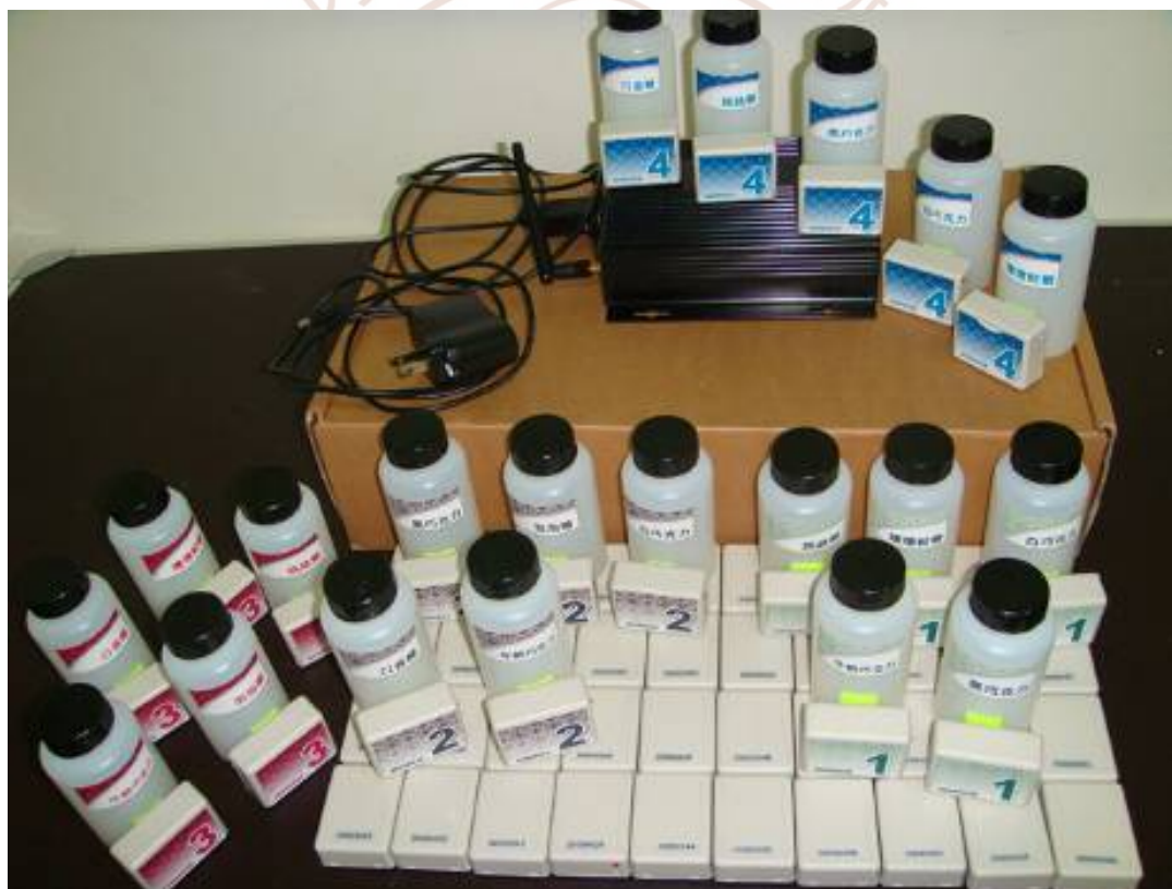
圖 3-28 開發完成後之第三代用藥提醒 Reader 與 Tags
