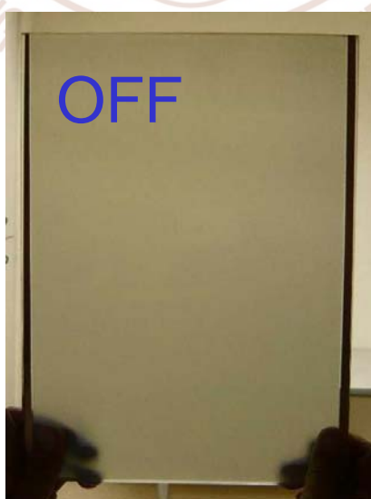
圖 2-17 智慧型節能窗(A4 尺寸)在不通電狀態下呈現不透明
