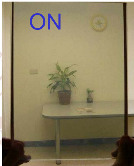
圖 2-19 智慧型節能窗(A4 尺寸)在通電狀態下呈現透明
