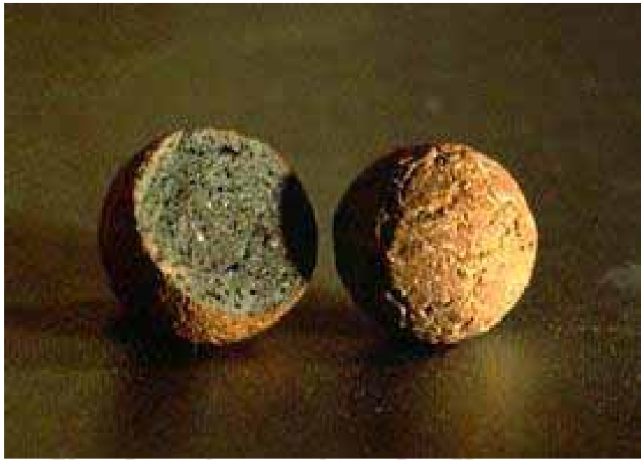
圖 2-1 良好的輕質粒料具堅硬的外殼以滯含內部的孔隙 [1, 2]
