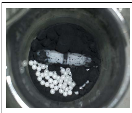
圖 3.40. SDS 於奈米碳管分散後再球磨
