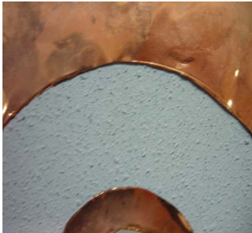
圖 3.18 未經液態球磨之 CNT/油漆試片
