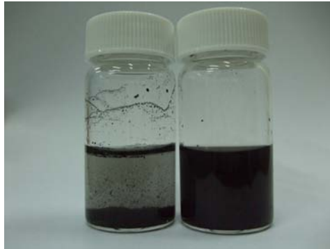
圖 3.21 CNT 和 SDS-CNT 於水溶劑中的比較
