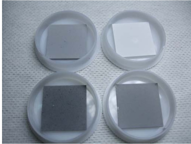
圖 3.7 將不同奈米碳管濃度之油漆 Spin Coater 塗佈在壓克力板
