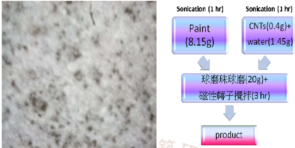
圖 3.12 球磨珠液態球磨實驗步驟之其 OM 圖
