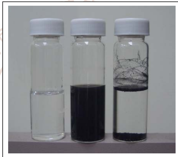
圖 3.36 添加 SDS 與未添加 SDS 奈米碳管的比較
