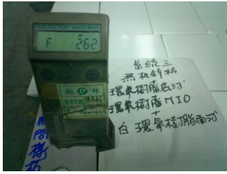
圖 5-2 面漆為環氧樹脂試片的製作過程
