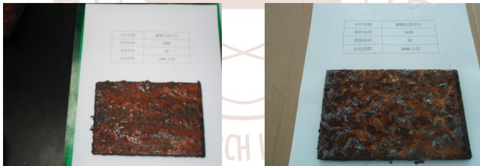
圖附 3-6 碳鋼各階段劣化情形 (無塗裝;鹽霧加速劣化)
