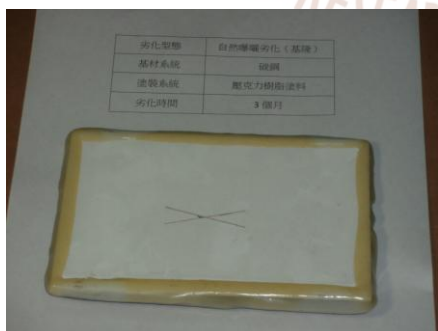
圖附 3-12 碳鋼各階段劣化情形（壓克力樹脂塗裝；自然曝曬劣化）
