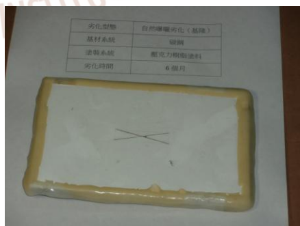
圖附 3-12 碳鋼各階段劣化情形（壓克力樹脂塗裝；自然曝曬劣化）
