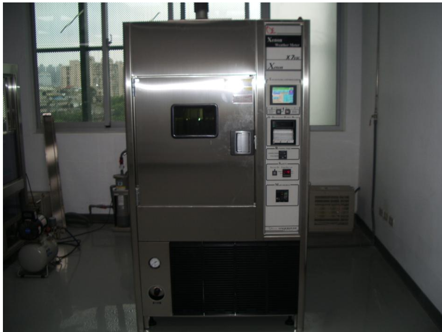
圖 7-7 建研所設置 SUGA X75 氙弧燈耐候試驗機 (本研究自行整理)
