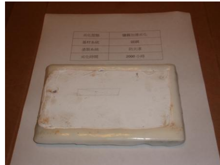
圖附 3-10 碳鋼各階段劣化情形（防火漆塗裝；鹽霧加速劣化）
