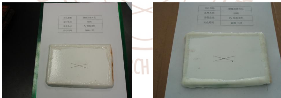
圖附 3-9 碳鋼各階段劣化情形(PU 樹脂塗裝;鹽霧加速劣化)
