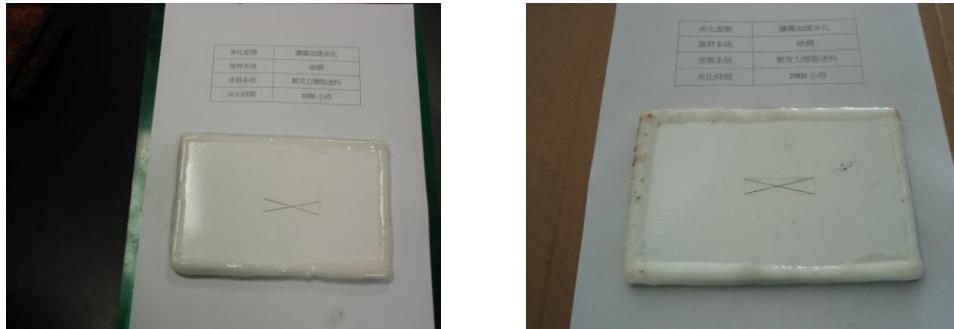
圖附 3-7 碳鋼各階段劣化情形(壓克力樹脂塗裝;鹽霧加速劣化)
