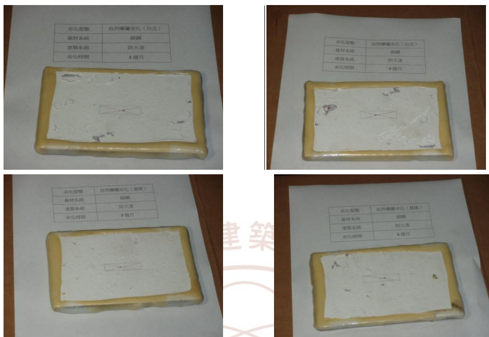
圖附 3-15 碳鋼各階段劣化情形 (防火漆塗裝；自然曝曬劣化)
