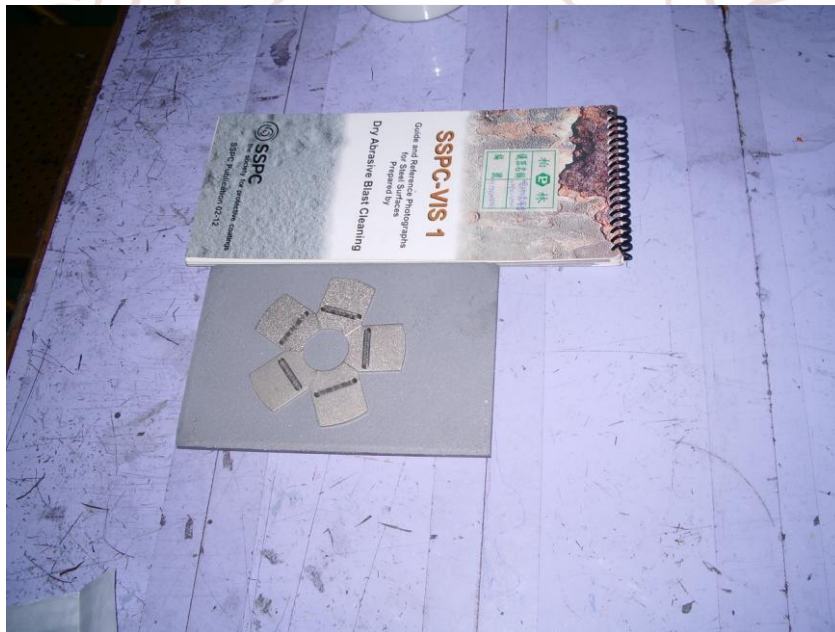
圖 5-1 以圖卡確認碳鋼試片噴砂達到 SSPC-SP-10 等級
