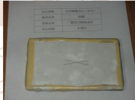
圖附 3-11 碳鋼各階段劣化情形（無塗裝；自然曝曬劣化）
