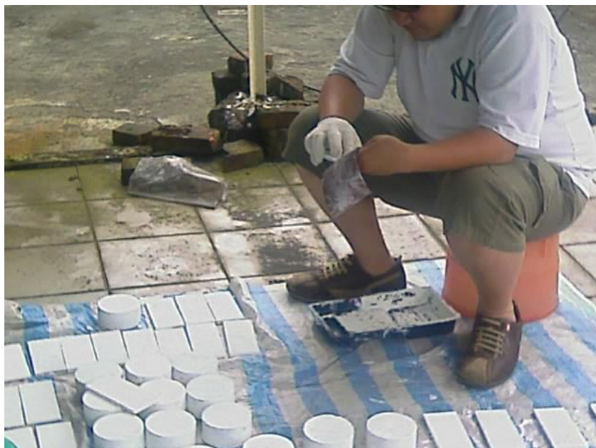
圖 5-3 木材試片塗裝過程
