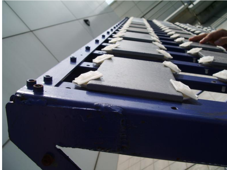
圖 7-4 試片安裝所使用之 PP 材質之螺栓與絕緣墊片
