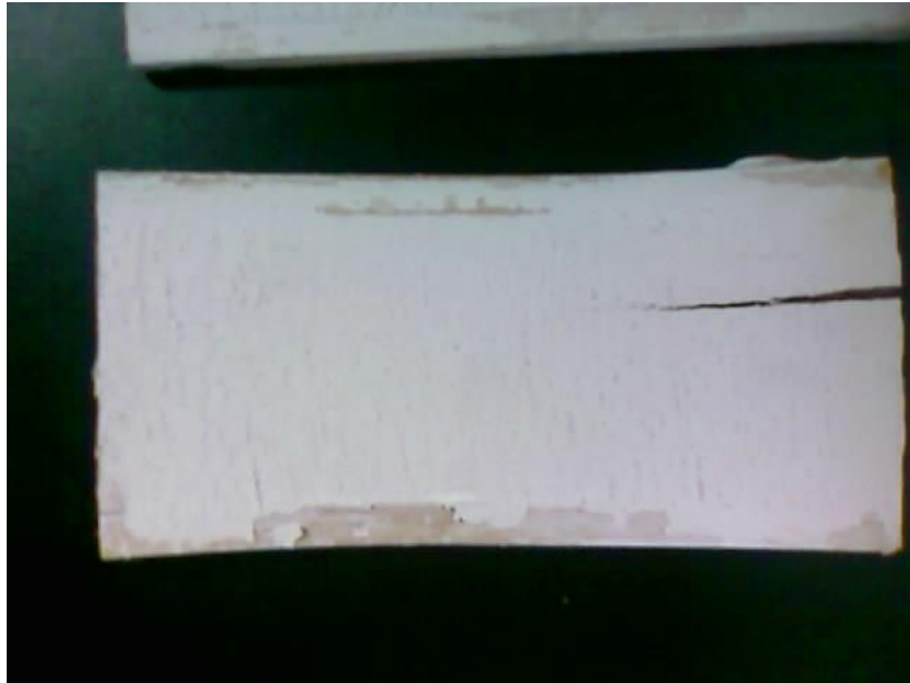
圖 6-6 木板基材防火漆塗裝經日光劣化 2000 小時後情形
