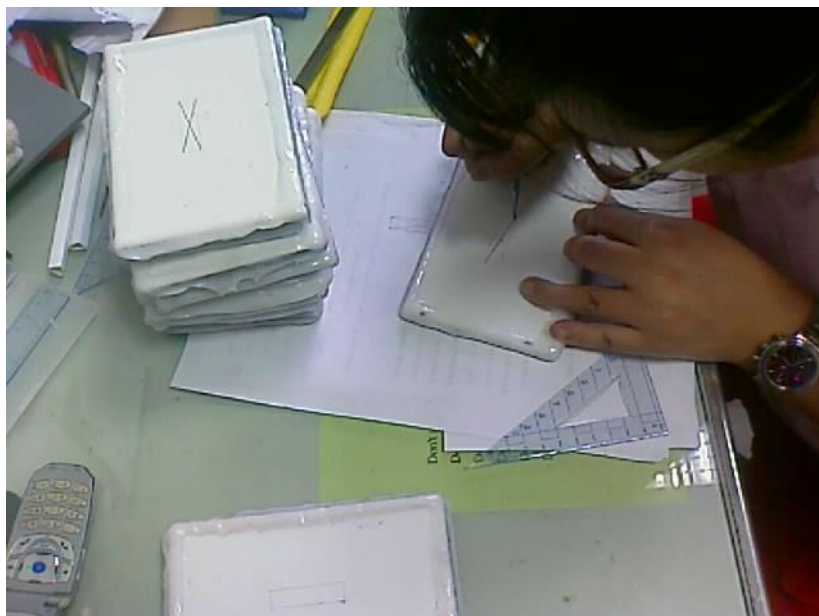
圖 5-5 試片 X 形刻痕製作
