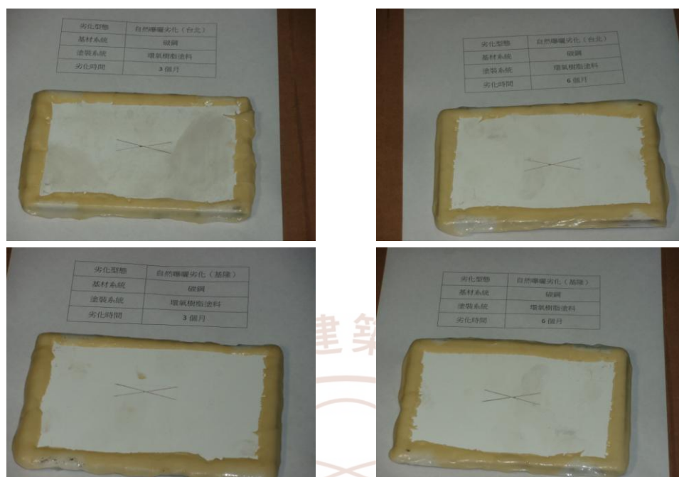
圖附 3-13 碳鋼各階段劣化情形(環氧樹脂塗裝;自然曝曬劣化)
