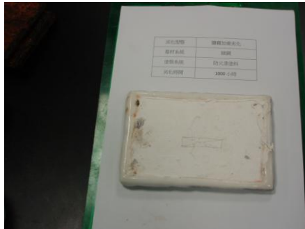
圖附 3-10 碳鋼各階段劣化情形（防火漆塗裝；鹽霧加速劣化）
