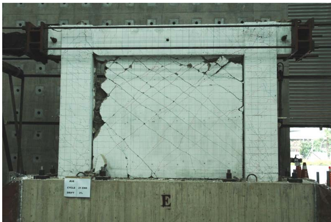
圖 4-19 AI4 試體層間變位 3% 實驗結束之照片 (資料來源：本研究拍攝)
