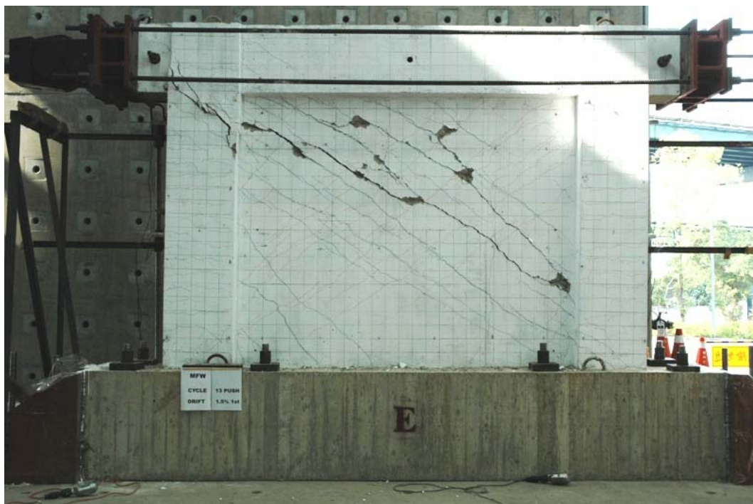
圖 4-9 MFW 試體層間變位 1.5% push (1 st )之照片 (資料來源：本研究拍攝)
