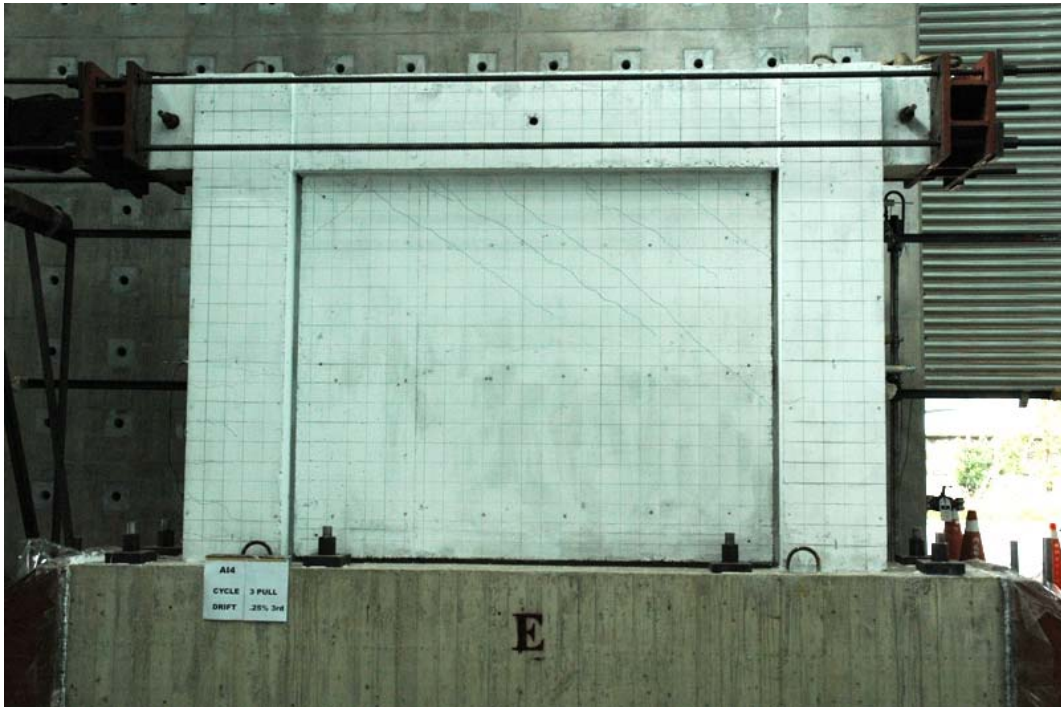
圖 4-17 AI4 試體層間變位 0.25% pull (3 rd )之照片 (資料來源：本研究拍攝)
