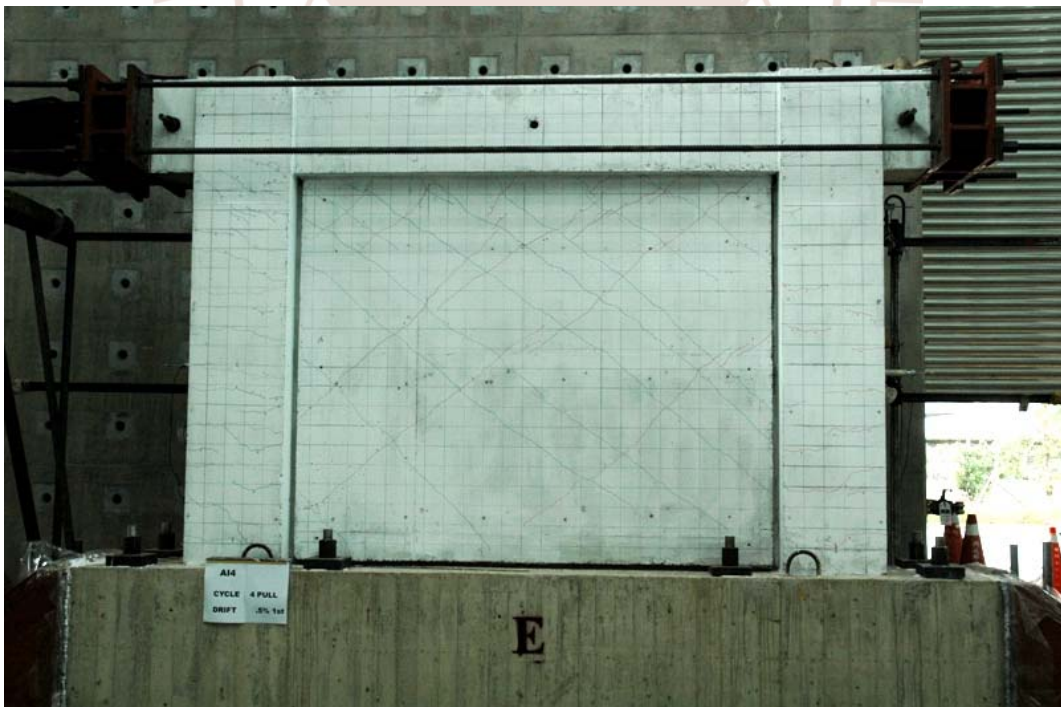
圖 4-18 AI4 試體層間變位 0.5% pull (1 st )之照片 (資料來源：本研究拍攝)
