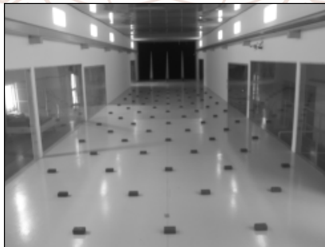
圖 3-1 C 地況地表粗糙元設置照片圖 (資料來源：本研究整理)
