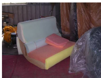
圖 3-46 沙發製作圖(泡棉填實)
