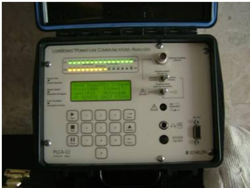
圖 5-23 電力線傳輸測試 (信號發送端)
