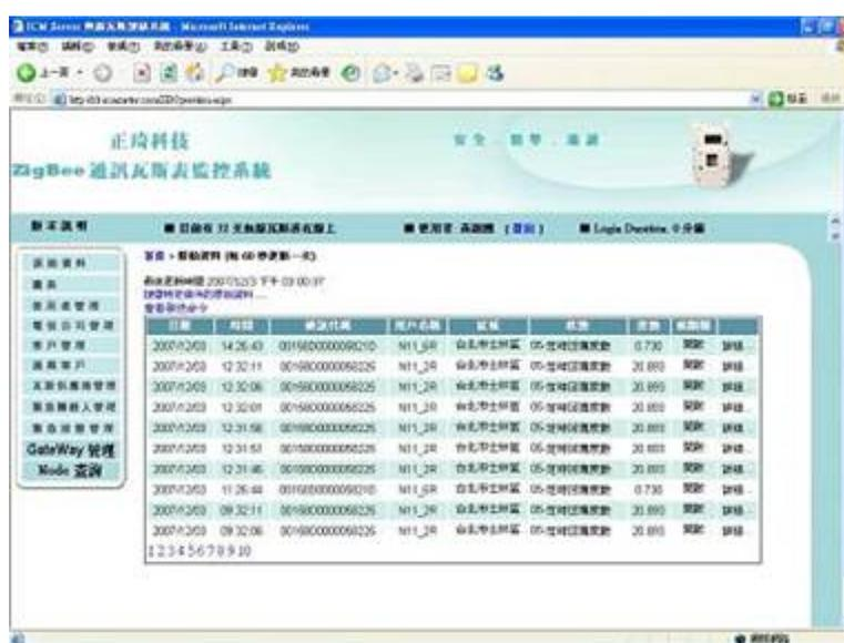
圖 5-36 數位瓦斯表傳輸測試畫面
