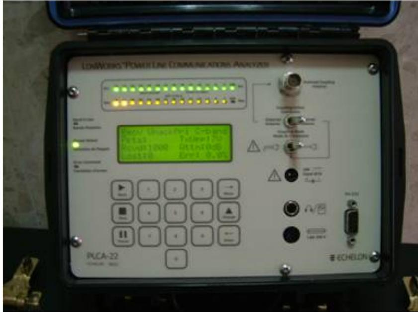
圖 5-22 電力線傳輸測試 (信號接收端)
