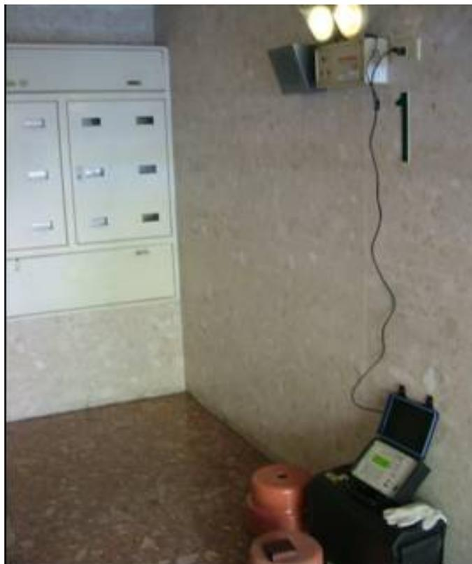
圖 5-24 電力線通訊傳輸測試(1)
