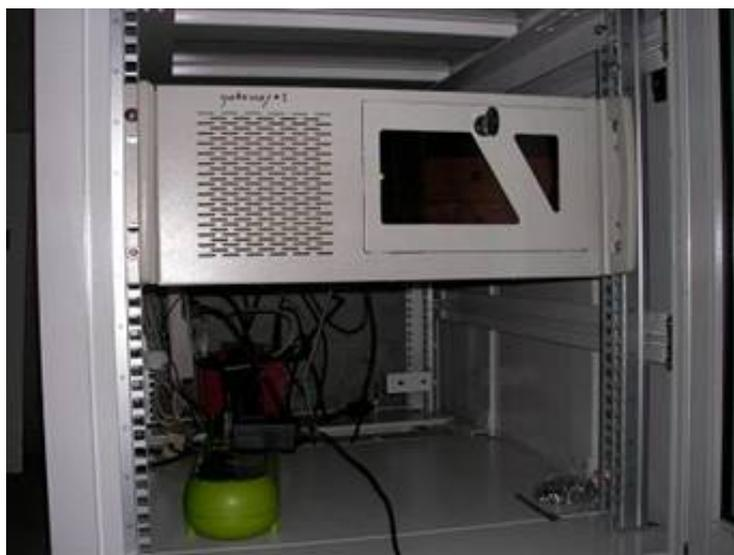
圖 5-35 數位瓦斯表 Gateway (Zigbee)
