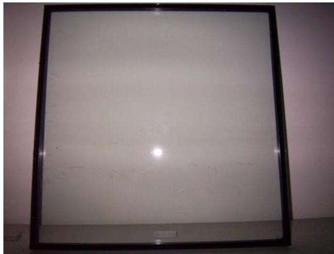
圖 3-14 5mm+HM75+6A+5mm 複層玻璃試件
