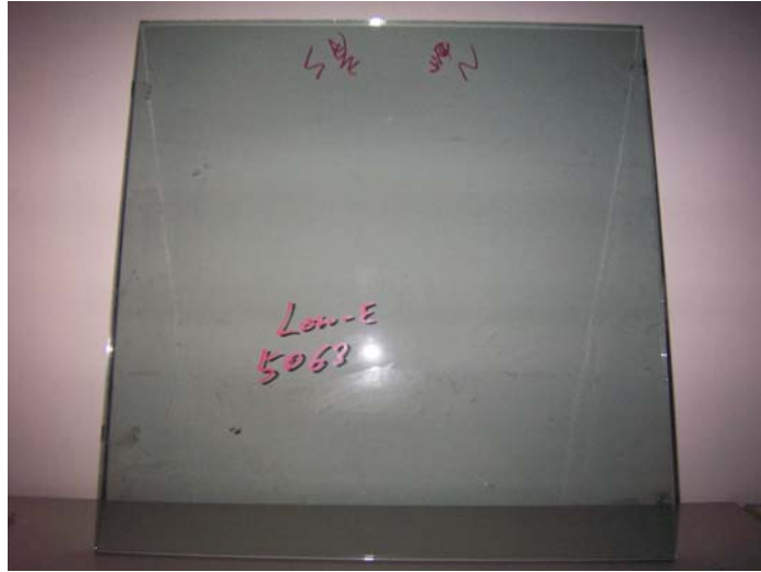
圖 3-8 5mm+DLE-63+5mm 膠合玻璃膠合玻璃試件
