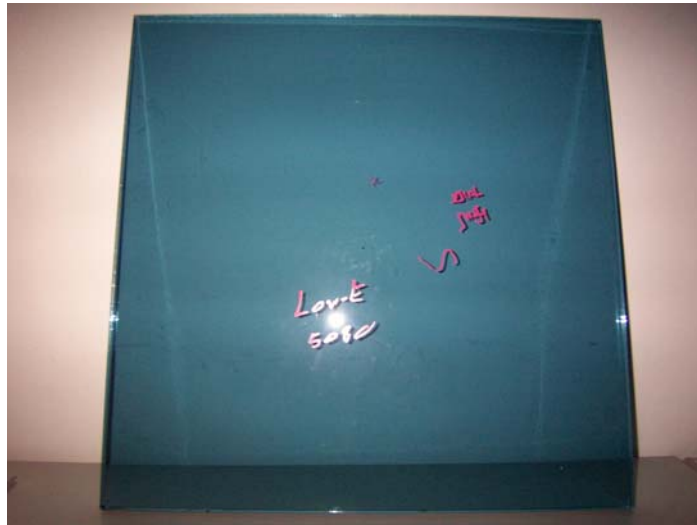
圖 3-10 8mm+SLE80+8mm 膠合玻璃試件
