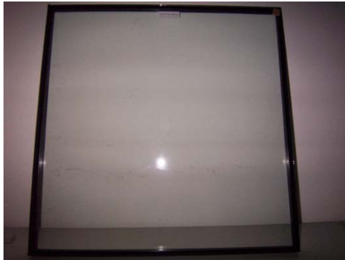
圖 3-12 5mm+12A+5mm 複層玻璃試件
