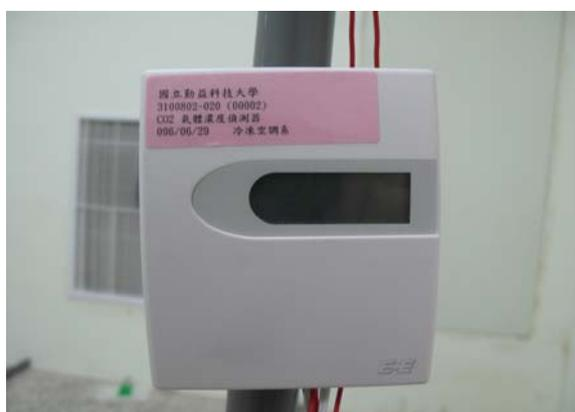
圖 4-8 奧地利 E+E CO<sub>2</sub> 濃度感測器
