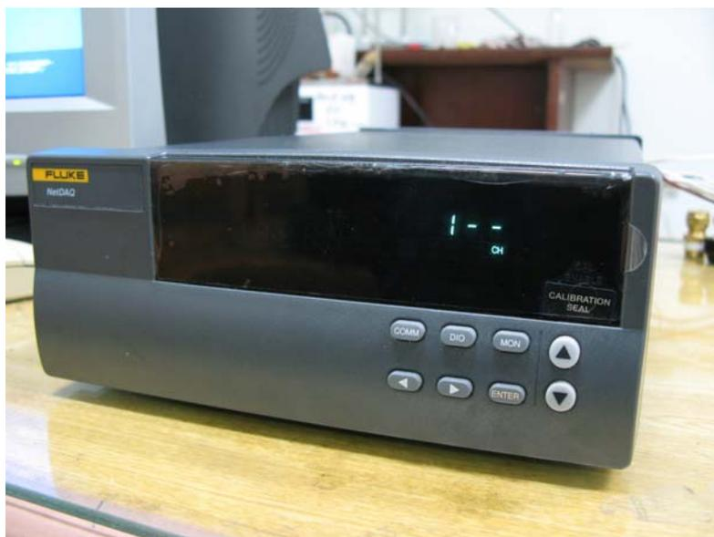
圖 4-10 資料擷取器 Fluke NetDAQ Logger Model 2640A 型
