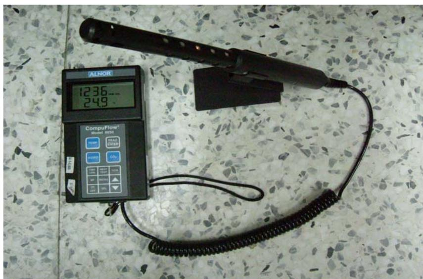
圖 4-7 ALNOR Model 8650 型 CO<sub>2</sub> 濃度測棒
