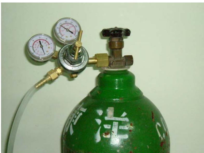
圖 4-11 CO<sub>2</sub> 氣體鋼瓶
