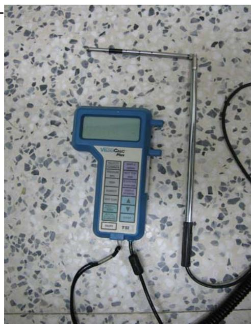
圖 4-6 TSI 風速/溫濕度計
