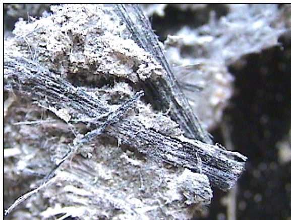
圖 3-1.2 立體顯微鏡觀察纖維照片
