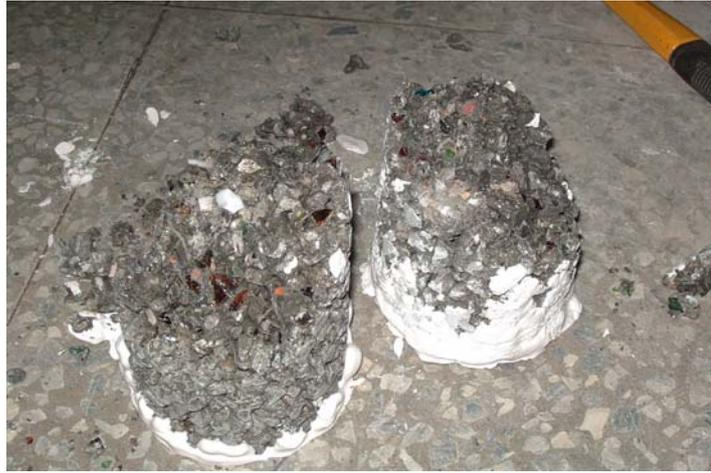
圖3-18 透水混凝土試體破壞情形
