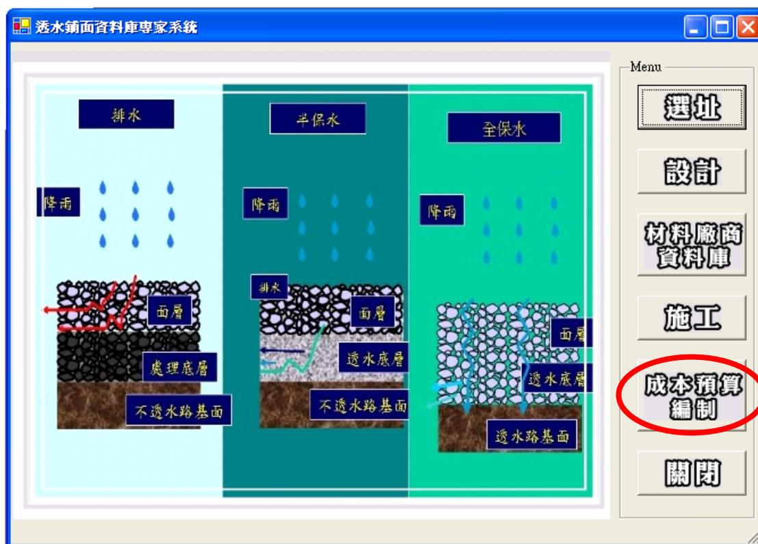
圖3-42 透水鋪面資料庫專家系統主畫面
