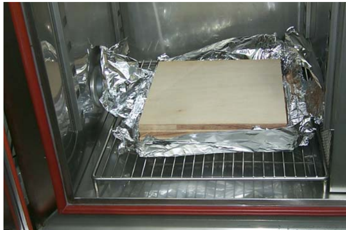
圖 3-4 建材樣品置於環控艙中
