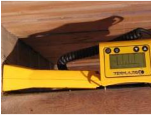
圖 2-8 TERMATRAC 白蟻偵測儀 (微波原理)
