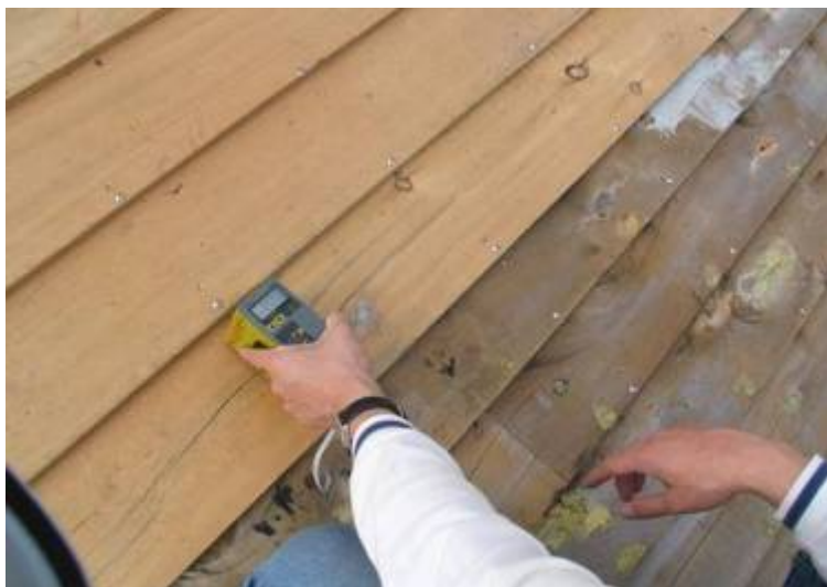
圖 2-2 高周波式含水率計測定木構件之含水率
