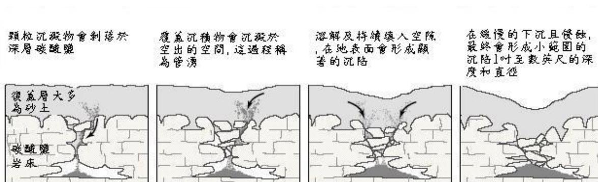
圖 2.14 覆蓋層下陷的坑洞示意圖
