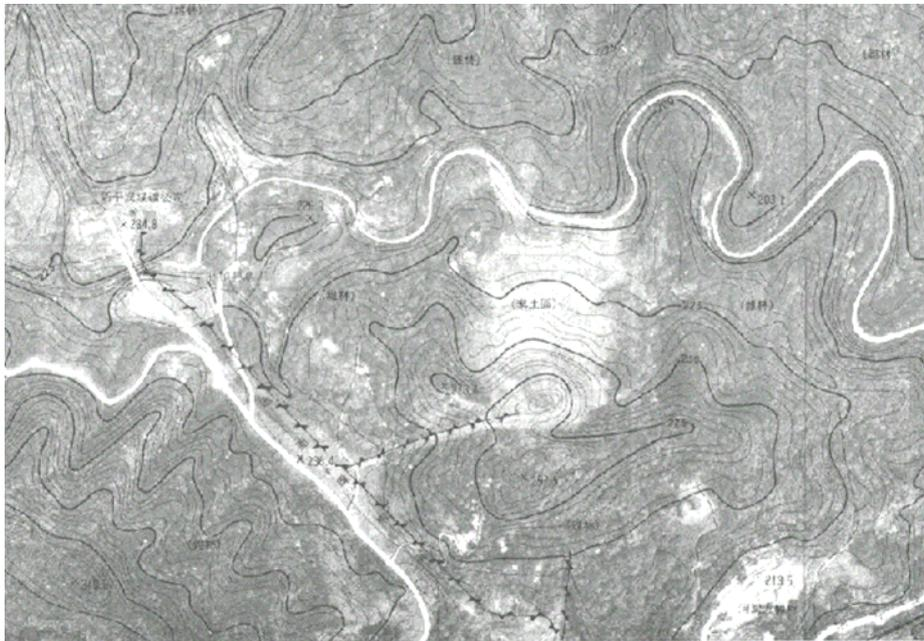
圖 3.23 五分山煤渣堆積（A 為坡頂煤渣堆積；B 為階梯式煤渣堆積；C 為煤坑索道）
