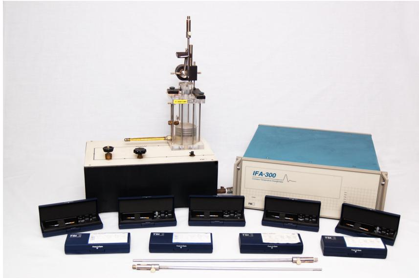
**圖 5-4 IFA-300 智慧型風速儀、探針及校正儀**
