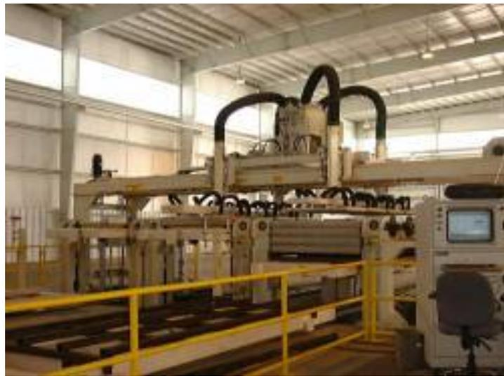
圖 2-8 廠型板胚的脫模處理情景 [25]
