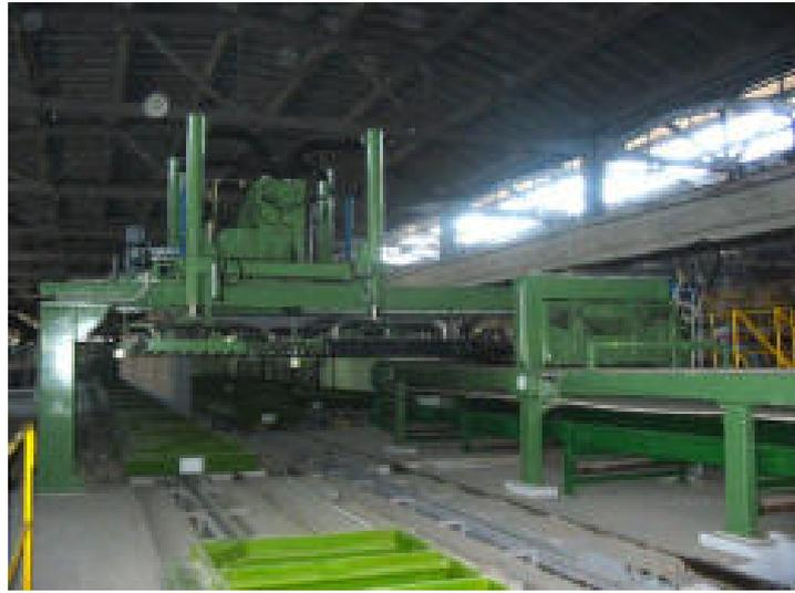
圖 2-6 廠型堆疊成型板材之設備 [25]
