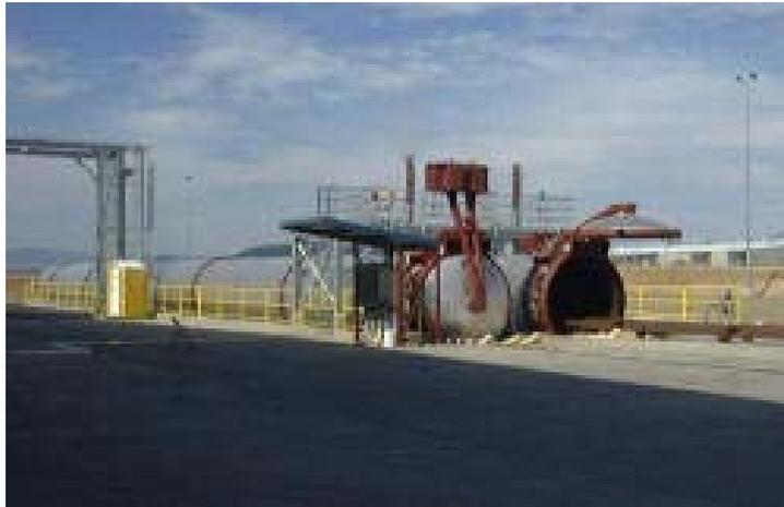
圖 2-9 廠型板胚自動高壓蒸氣養護裝置 [25]
