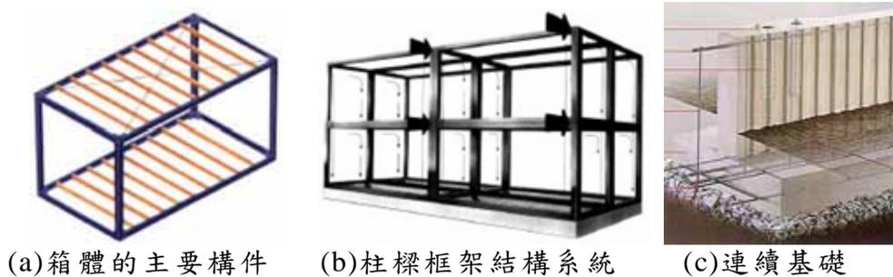
圖 4-16 國內「箱體式」住宅系統之箱體構造
