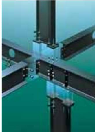
圖 5-26 H 型鋼柱、樑接合示意圖
