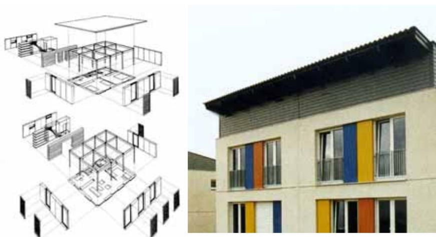
**圖 5-2 Dywidag System 系統分解圖(左)與 Siedlung Gaildorf 原型屋(右)**
