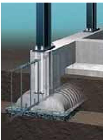
圖 5-25 RC 造連續基礎樣式/H 型鋼柱與基礎之接合
