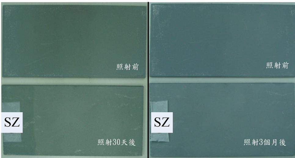
圖 4-31 UV-B 紫外燈照射 SZ 試片 30 天後外觀變化
