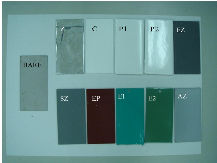
圖 4-15 浸漬強鹼溶液 24 小時塗層外觀
