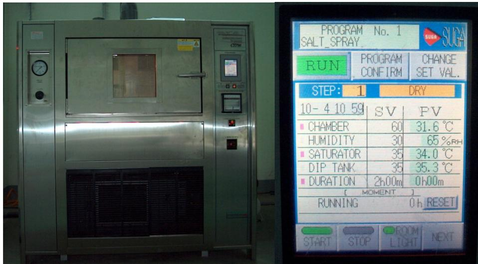
圖 3-4 鹽霧複合耐候試驗機與設定操作面板
