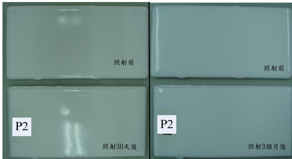
圖 4-29 UV-B 紫外燈照射後 P2 試片外觀變化
