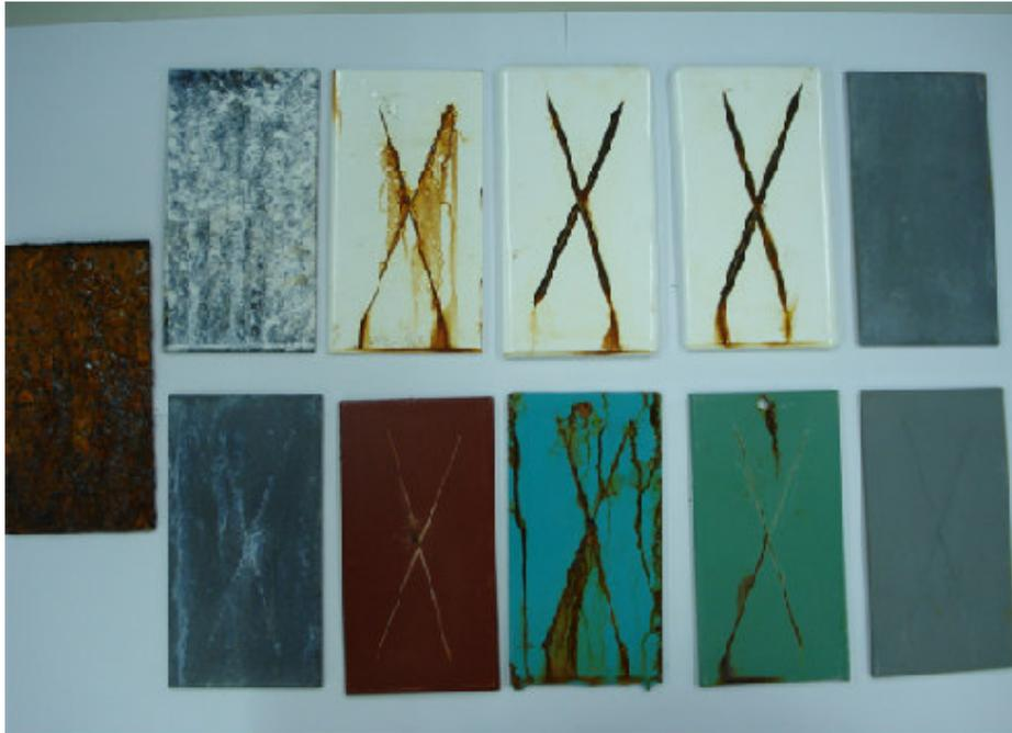
圖 4-20 鹽水噴霧試驗 2500 小時後塗層外觀
