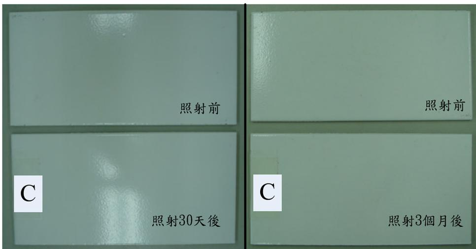
圖 4-27 UV-B 紫外燈照射後 C 試片外觀變化
