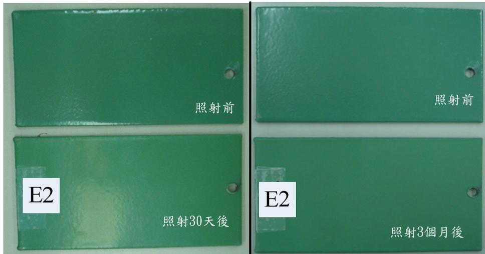
圖 4-34 UV-B 紫外燈照射 E2 試片 30 天後外觀變化
