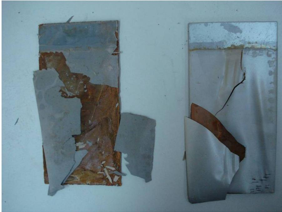
圖 4-12 EZ 及 AZ 試片耐酸試驗後外觀
