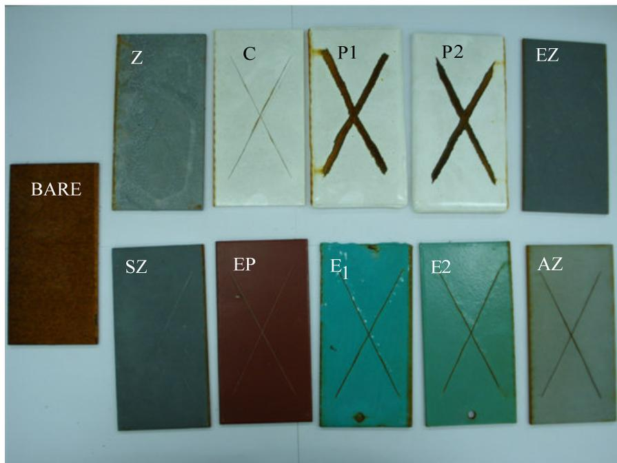
圖 4-37 曝曬試驗 2000 小時後塗層外觀
