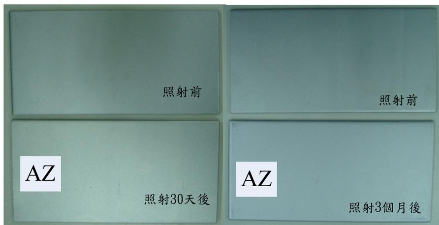
圖 4-35 UV-B 紫外燈照射 AZ 試片 30 天後外觀變化
