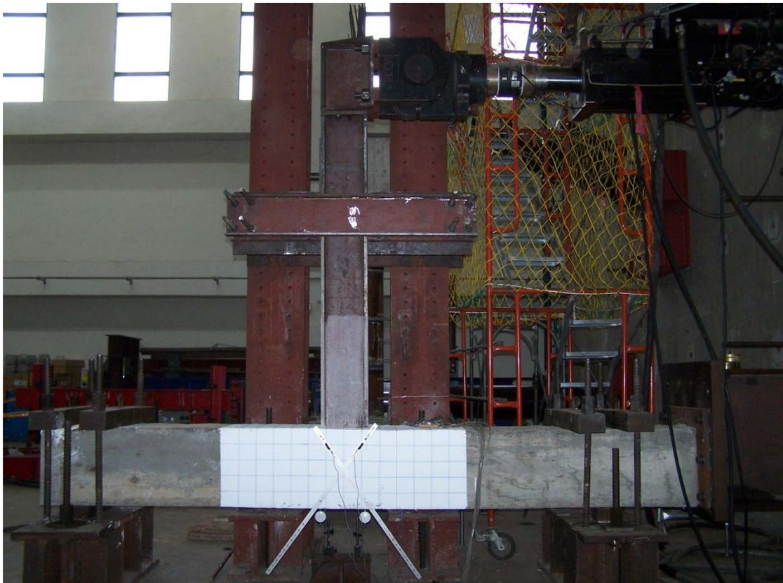
照片 3.6 試體試驗裝置
