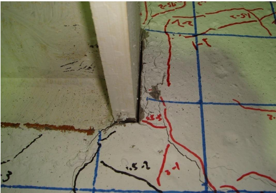
照片 4.30 試體 SR0.6-R6 鋼梁翼板周圍混凝土被擠壓約 2 mm 間隙 (3% drift)
