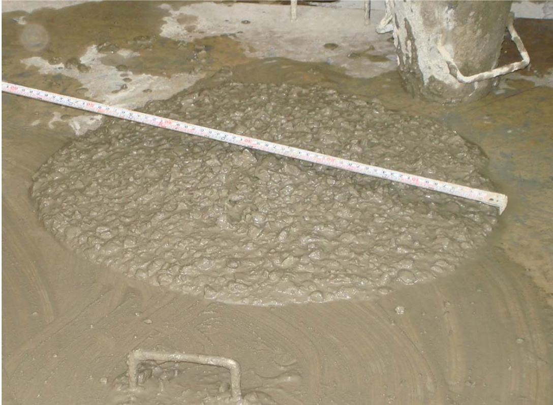
照片 3.3 自充填混凝土坍流度試驗 (55~65 cm)
