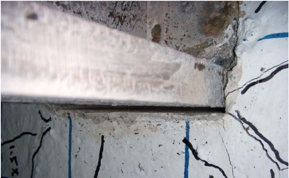
照片 4.4 試體 SR0.8-R8 鋼梁翼板周圍混凝土被擠壓約 3 mm 間隙
