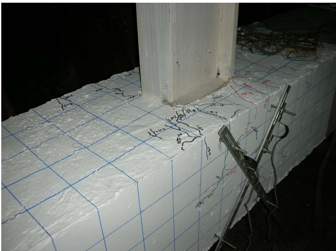
照片 4.6 試體 SR0.6-R8 裂縫發展情形 (1% drift)
