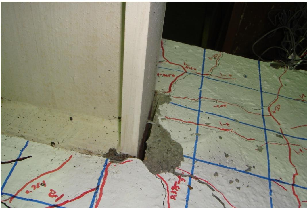
照片 4.38 試體 SR0.4-R6 鋼梁翼板周圍混凝土被擠壓約 5 mm 間隙 (3% drift)
