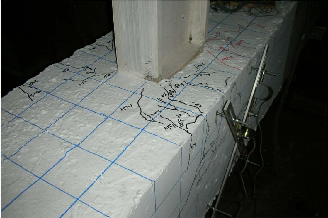
照片 4.7 試體 SR0.6-R8 裂縫發展情形 (1.5% drift)
