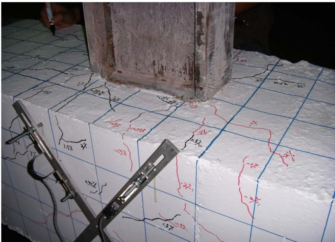
照片 4.2 試體 SR0.8-R8 裂縫發展情形 (2% drift)
