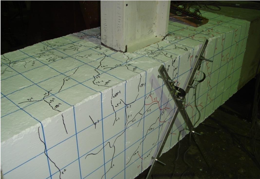
照片 4.29 試體 SR0.6-R6 裂縫發展情形 (3% drift)
