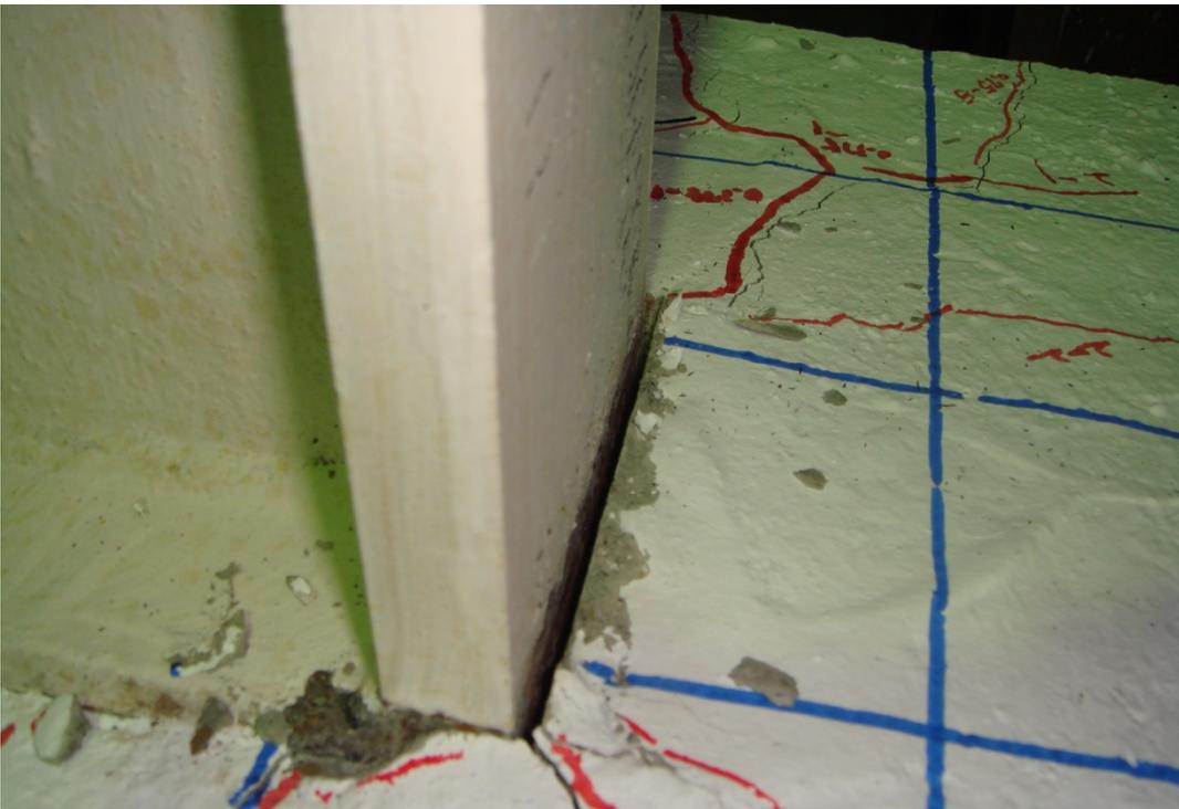
照片 4.36 試體 SR0.4-R6 鋼梁翼板周圍混凝土被擠壓約 3 mm 間隙 (3% drift)
