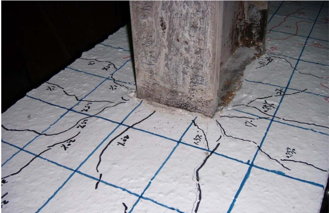
照片 4.1 試體 SR0.8-R8 鋼梁下翼板石灰剝落與裂縫情況 (1% drift)
