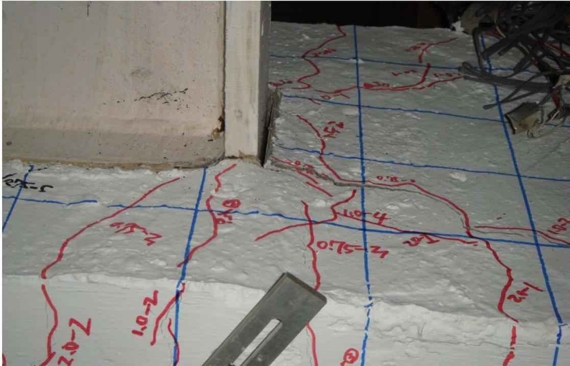
照片 4.9 試體 SR0.6-R8 鋼梁翼板周圍混凝土被擠壓約 2 mm 間隙 (3% drift)
