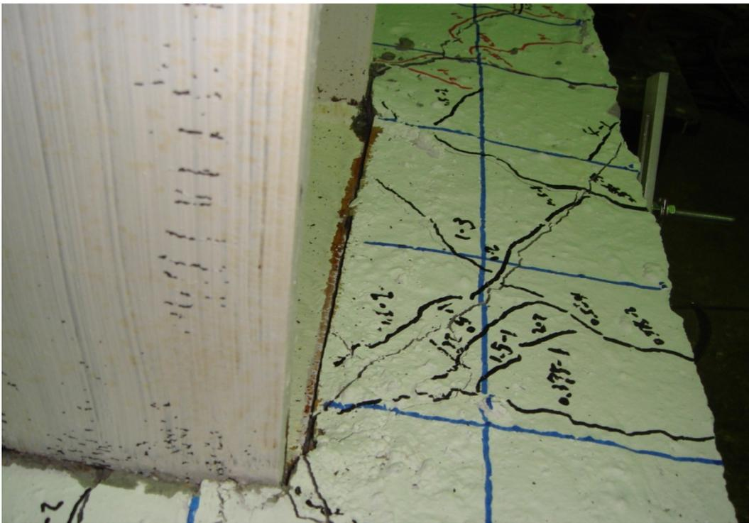
照片 4.32 試體 SR0.6-R6 承壓面板被拉開 (4% drift)
