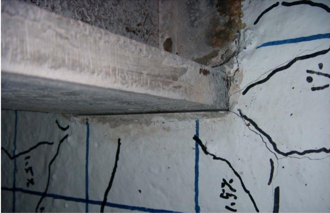
照片 4.3 試體 SR0.8-R8 鋼梁翼板周圍混凝土被擠壓約 1 mm 間隙
