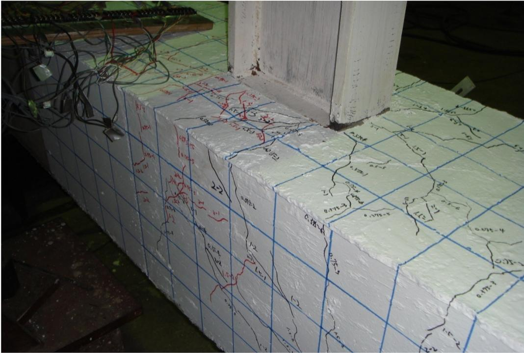
照片 4.27 試體 SR0.6-R6 裂縫發展情形 (2% drift)
