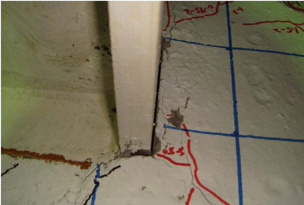
照片 4.28 試體 SR0.6-R6 鋼梁翼板周圍混凝土被擠壓約 1 mm 間隙 (2% drift)
