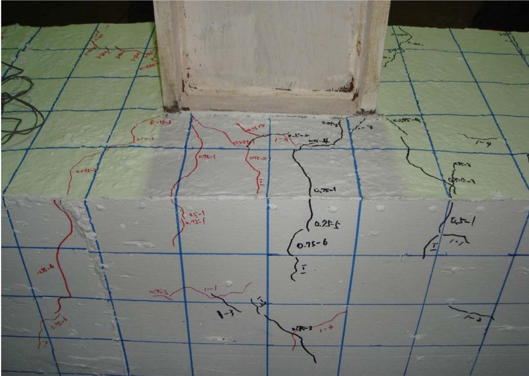
照片 4.19 試體 SR0.8-R6 裂縫發展情形 (1% drift)
