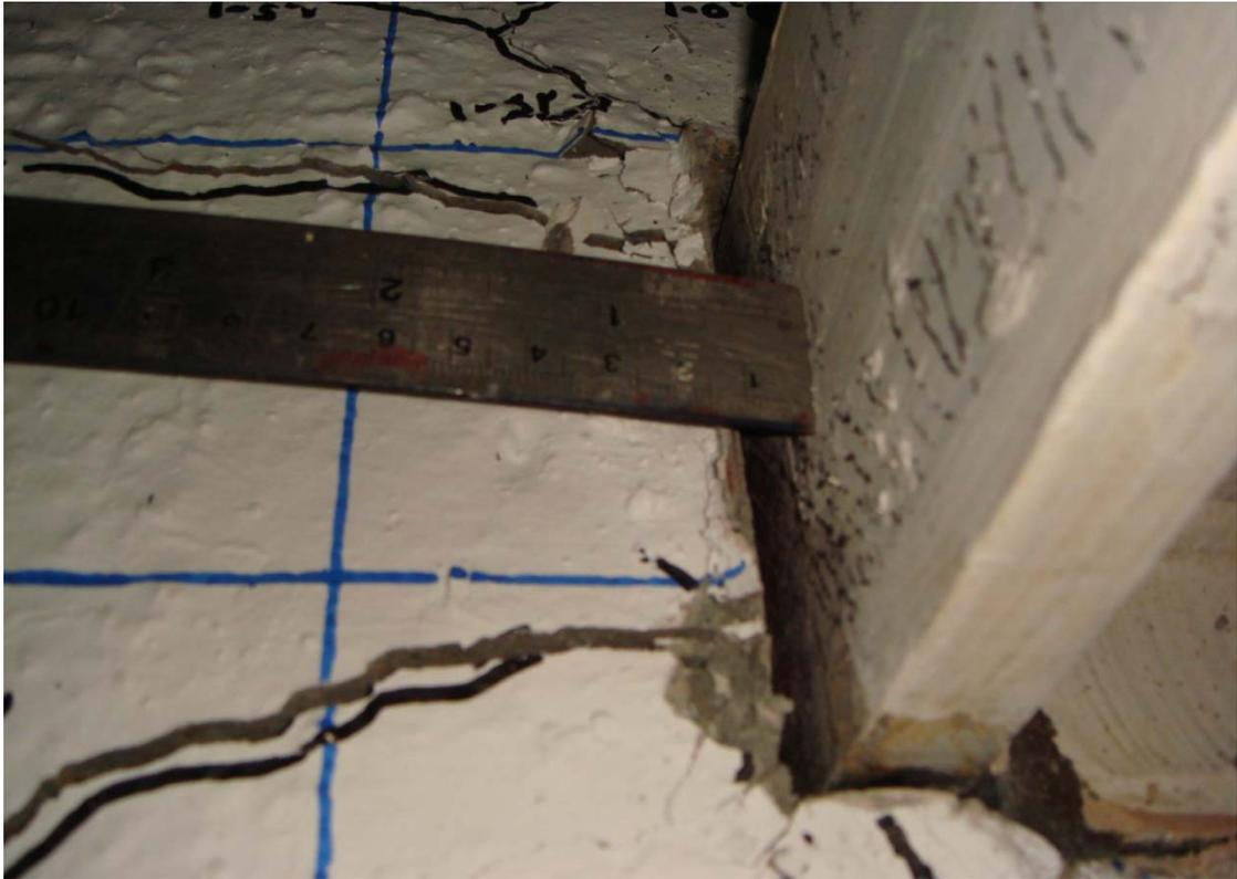
照片 4.11 試體 SR0.6-R8 鋼梁翼板周圍混凝土被擠壓約 3 mm 間隙 (4% drift)
