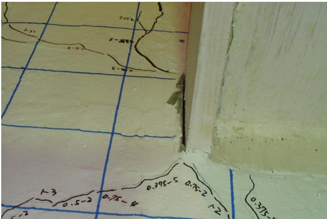
照片 4.14 試體 SR0.4-R8 鋼梁翼板周圍混凝土被擠壓約 1 mm 間隙 (2% drift)
