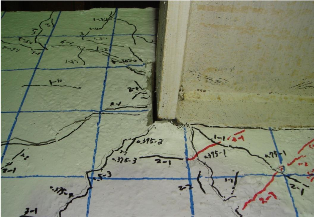
照片 4.23 試體 SR0.8-R6 鋼梁翼板周圍混凝土被擠壓約 5 mm 間隙 (4% drift)
