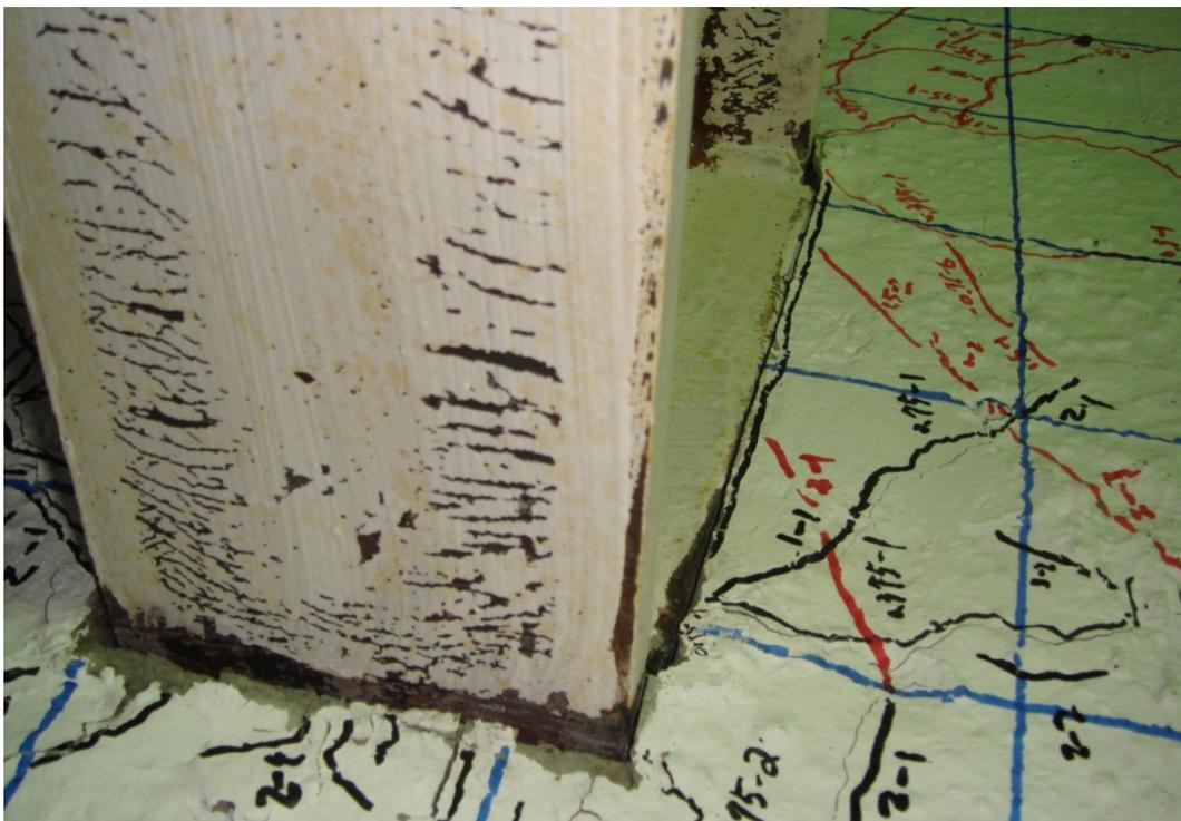
照片 4.24 試體 SR0.8-R6 鋼梁翼板與混凝土之裂縫情形 (4% drift)
