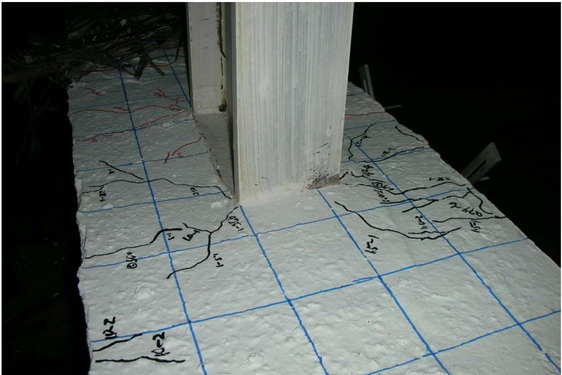
照片 4.8 試體 SR0.6-R8 裂縫情況 (2% drift)
