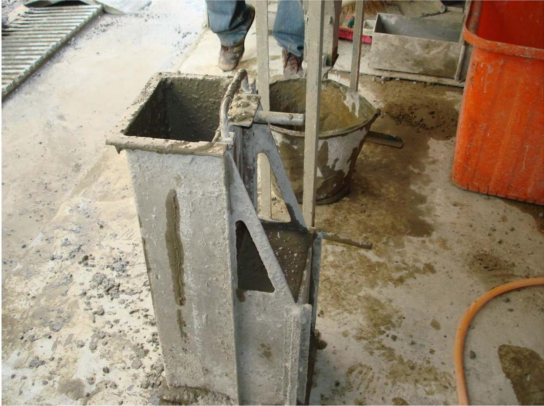
照片 3.5 自充填混凝土 U 型試驗
