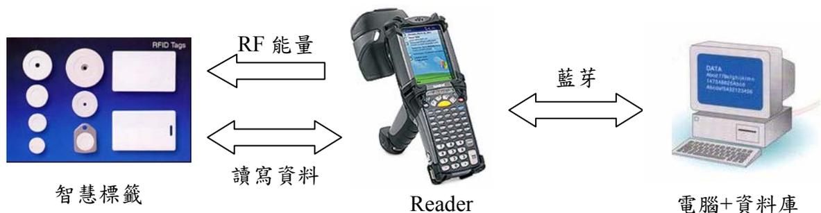
圖 2.1 RFID 系統基本架構圖
