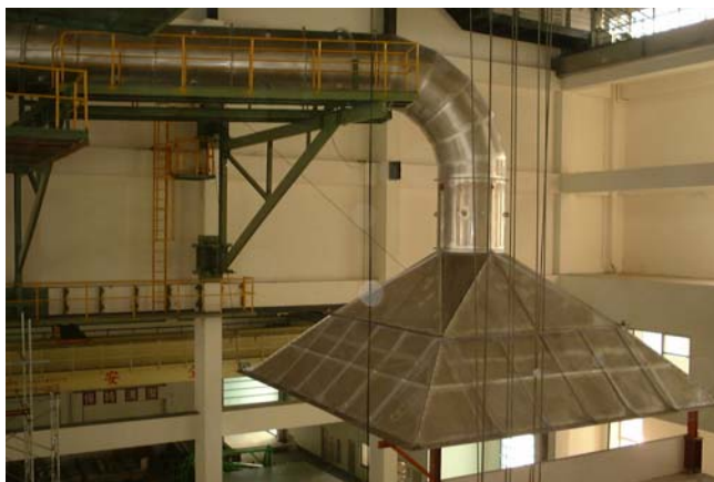
圖 2-1 大尺度燃燒分析裝置實際設備圖
