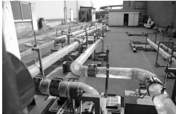
圖 3.24 株式會社クボタ 15 層排水實驗塔排水橫管 彎折配管排水實驗實況（攝影：林孟昭）
