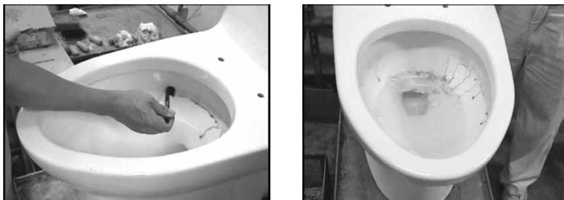
圖 3.16 衛生器具（馬桶及小便斗）內部髒污潔淨能力測試圖
