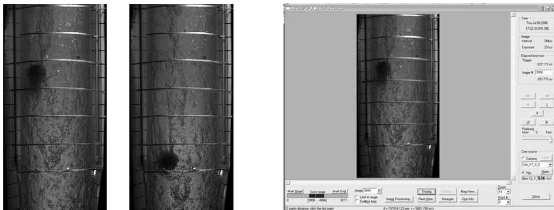
排水立管底部模擬污物流速觀測比較
