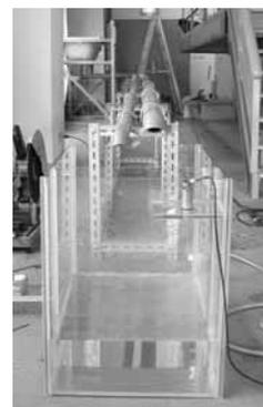
圖 3.39 衛生器具排水流率測定裝置
