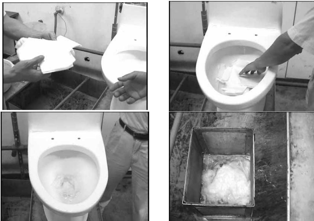
圖 3.12 馬桶器具衛生紙（短纖維）清靜能力測試程序
