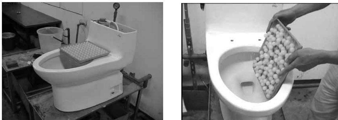
圖 3.13 馬桶器具標準尼龍球清靜能力測試程序圖
