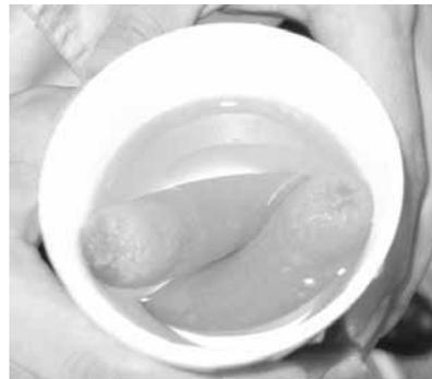
圖 3.43 排水橫管污物搬送實驗之模擬污物
