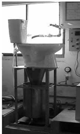
圖 3.10 馬桶器具 ASME 標準尼龍球清靜能力測試程序圖
