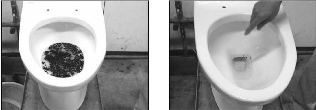
圖 3.14 馬桶器具 ASME 標準塑膠顆粒清靜能力測試程序圖
