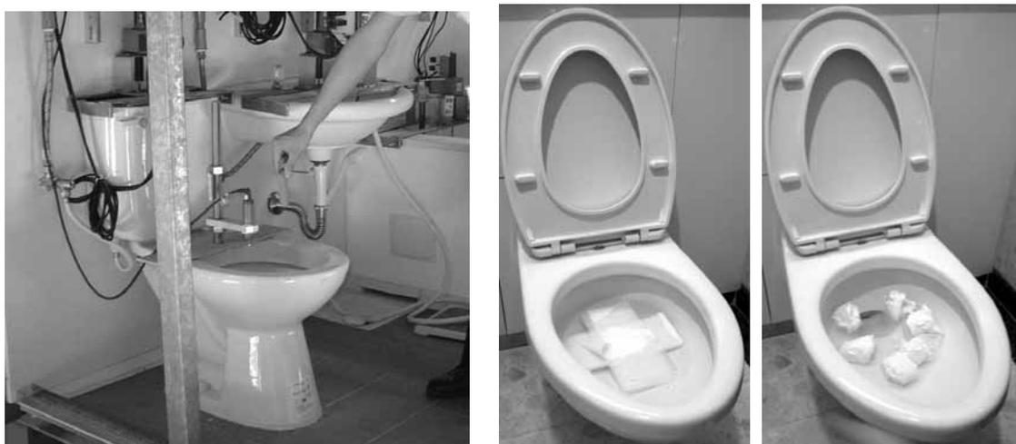
圖 3.41 排水性能實驗之試體與操作<sup>[4]</sup>
