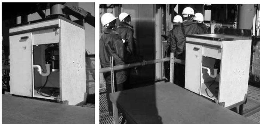
圖 3.28 日本東京八王子都市基盤整備公團 108m 排水實驗塔實驗用廚具與配管
