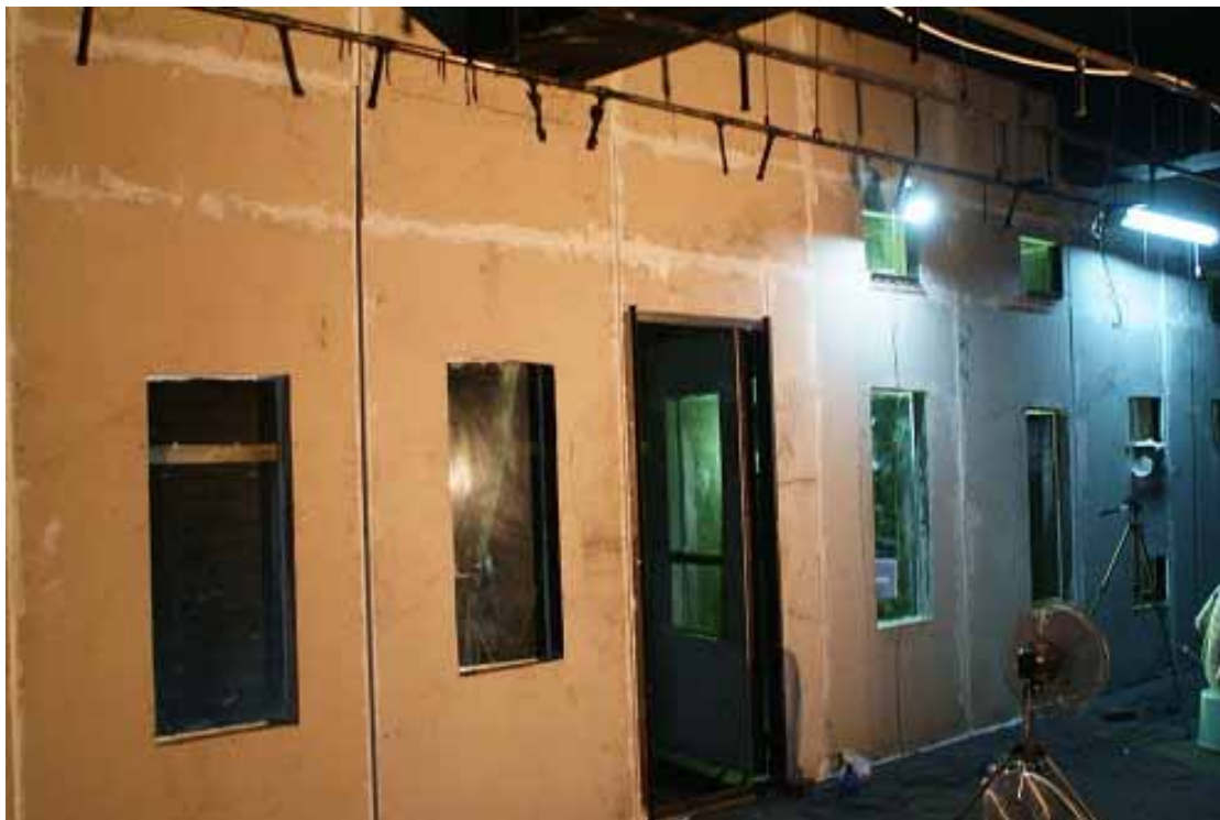
圖 3.7a 碳酸鈣板隔間外側(增設觀景窗)
