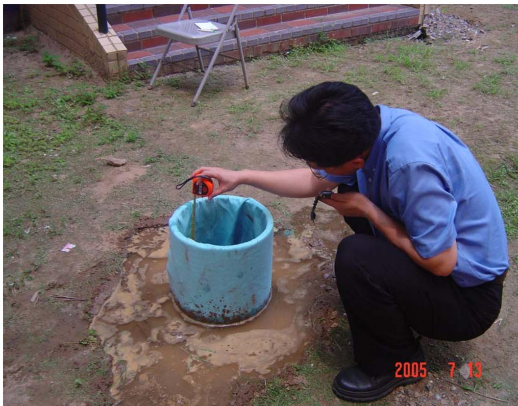
圖 5-21 試驗滲透陰井水位量測圖 (1)
