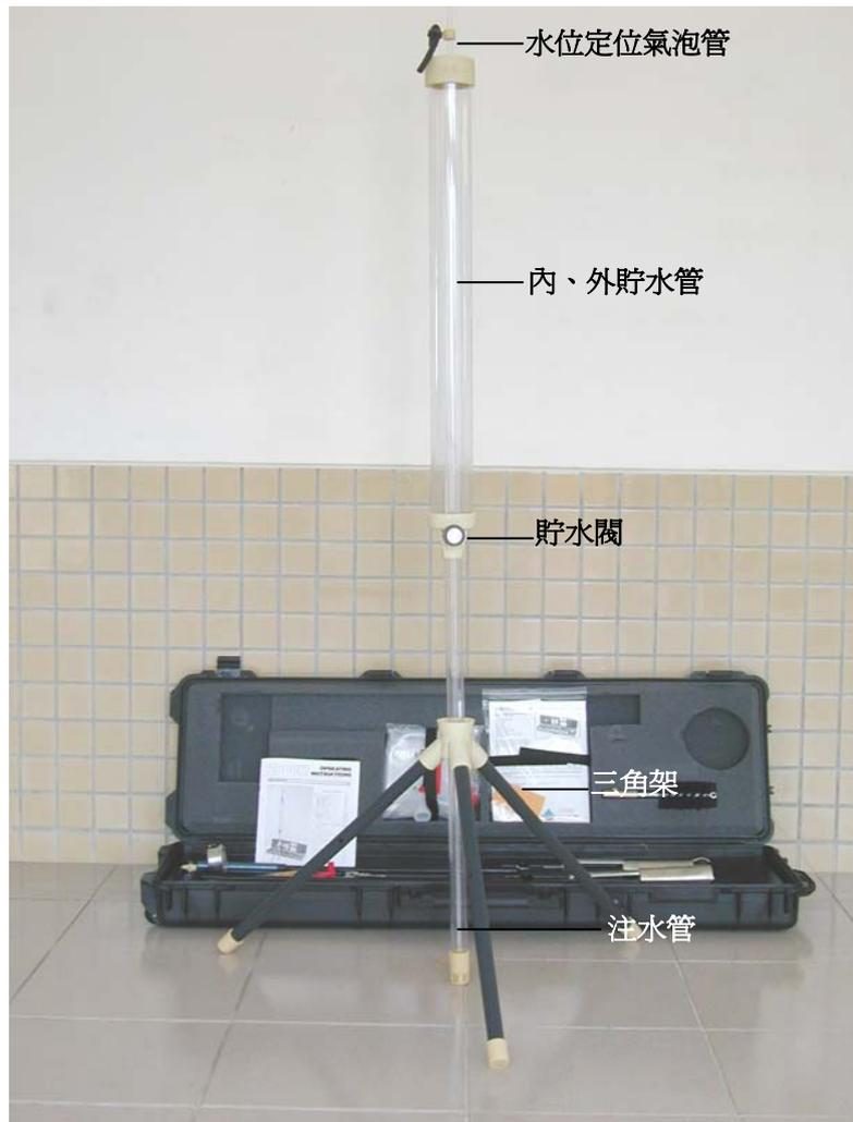
圖 5-3 葛洛夫滲透儀之基本構造
