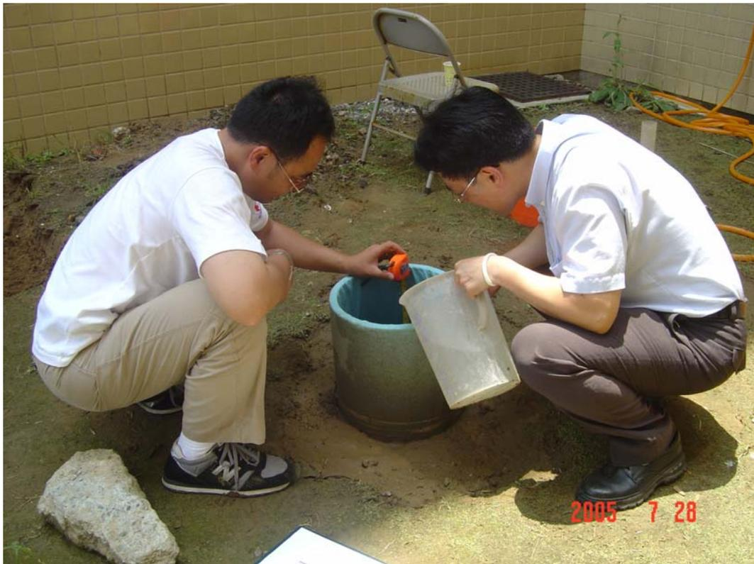
圖 5-23 試驗滲透陰井人工加水示意圖 (1)
