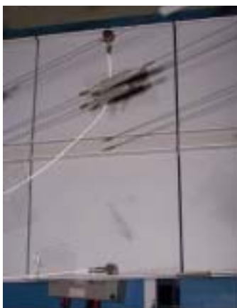
圖 2-16 加速度規佈設
