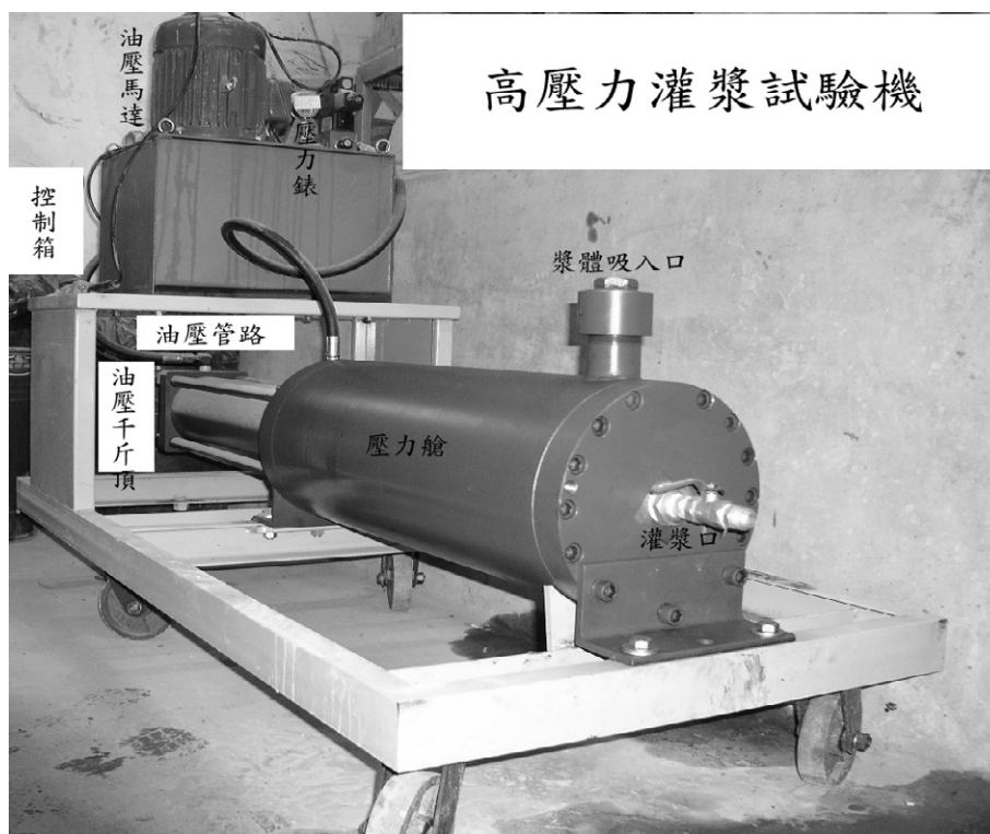
照片 4-4 高壓力灌漿試驗機 (資料來源：本研究拍攝)
