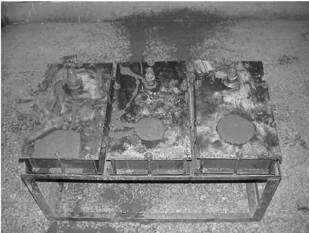
照片 3-4 當漿體從出漿孔溢出後即灌漿完成 (資料來源：本研究拍攝)
