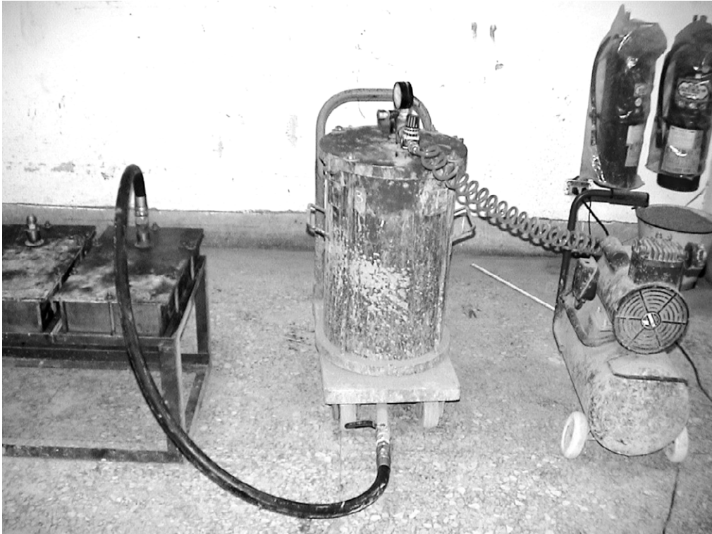
照片 3-3 將空氣壓縮機與試體連接於鋼筒上 (資料來源：本研究拍攝)
