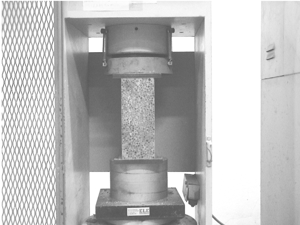
照片 3-7 抗壓強度試驗 (立放) (資料來源：本研究拍攝)
