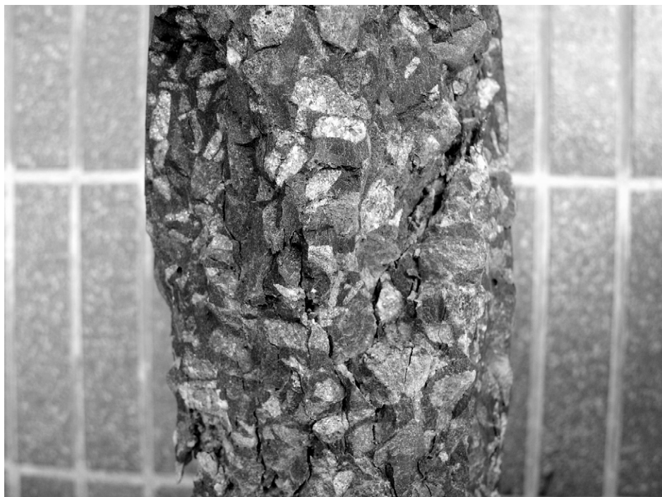
照片 4-8 抗壓試驗破壞面貫穿骨材 (資料來源：本研究拍攝)
