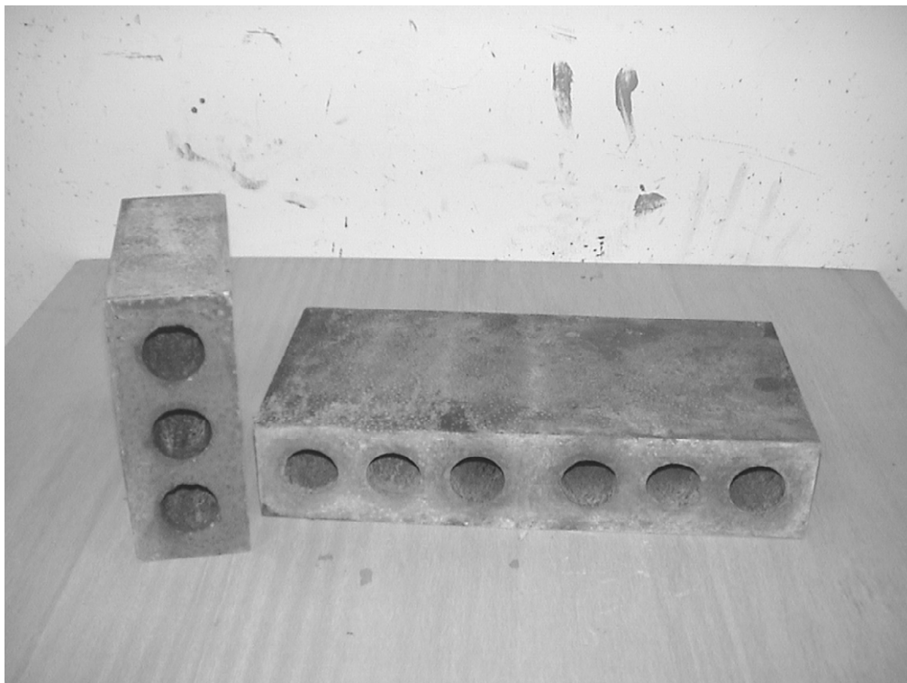
照片 3-5 灌製完成之試體表面平整 (資料來源：本研究拍攝)
