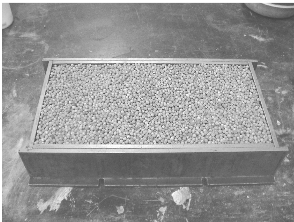
照片 3-2 將骨材振動夯實緻密填充於模具內
