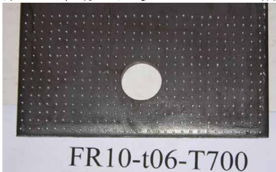
圖 5-16 設計溫度 706°C，邊距 0.5d 之 SN490C-FR 鋼板試體(實驗前)
