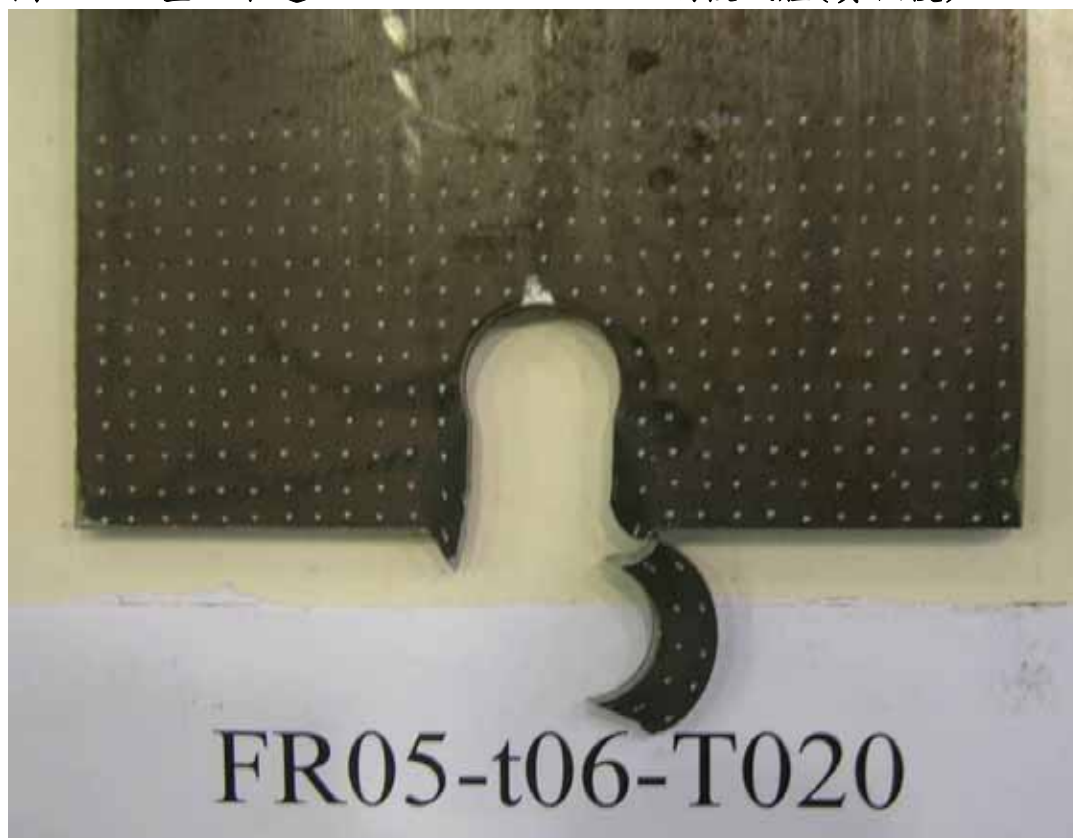
圖 5-16 設計溫度 706°C，邊距 0.5d 之 SN490C-FR 鋼板試體(實驗前)
