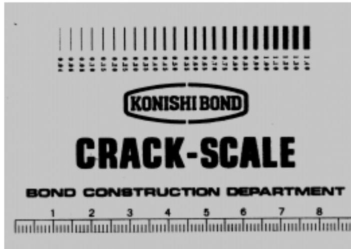
圖 3-34 裂縫測讀卡
