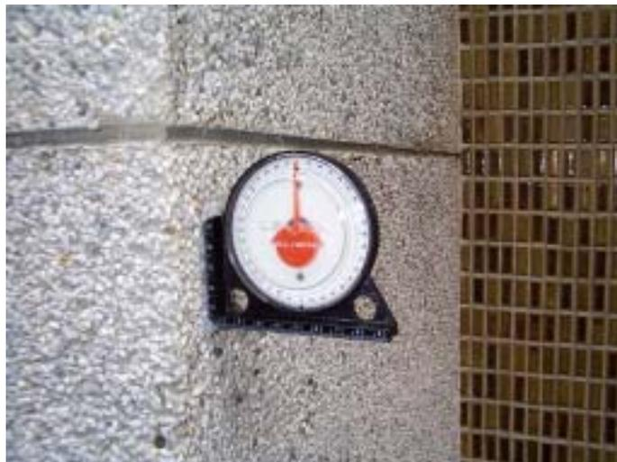
圖 3-27 簡易傾斜儀
