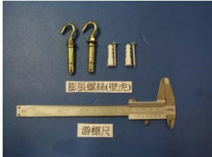
圖 3-33 簡易裂縫計使用材料
