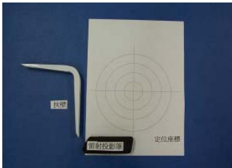
圖 3-30 簡易雷射位移計使用材料
