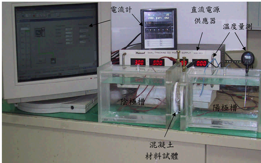
圖 2 ACMT 設備與電路連接圖
