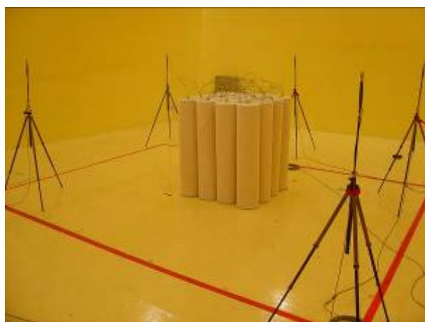
圖 7 吸音筒置地站立緊靠方形排列
