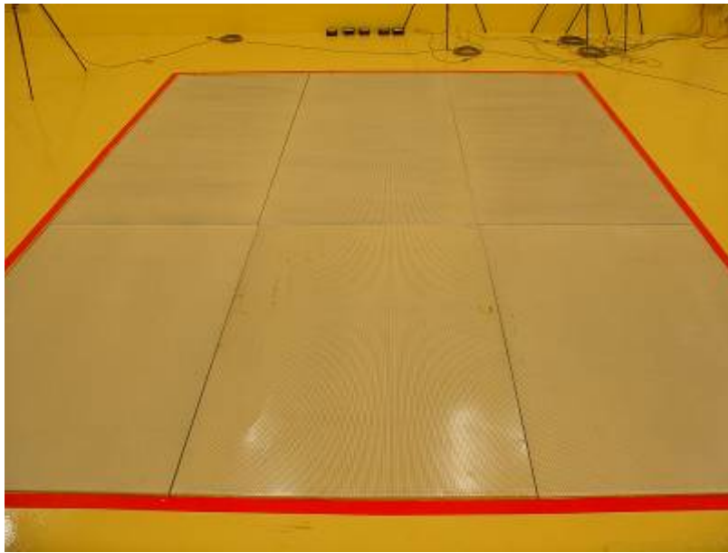
圖 20 量測不確定度分析使用之吸音材
