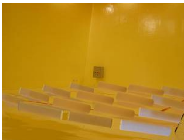
圖 9 吸音筒置地平躺規則排列
