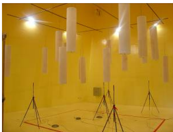
圖 4 吸音筒懸吊散亂排列
