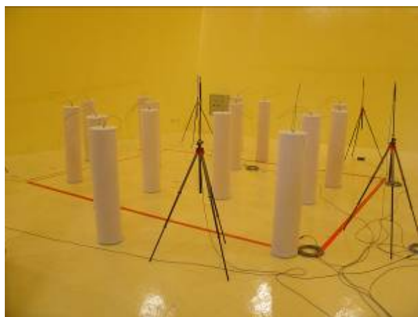
圖 6 吸音筒置地站立散亂排列
