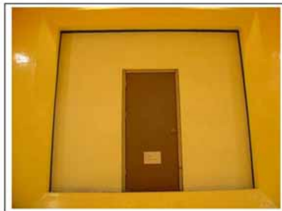
附圖二：測試件組裝完成照(受音側)
