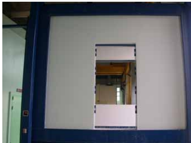
圖6 實驗室用隔音門測試框架
