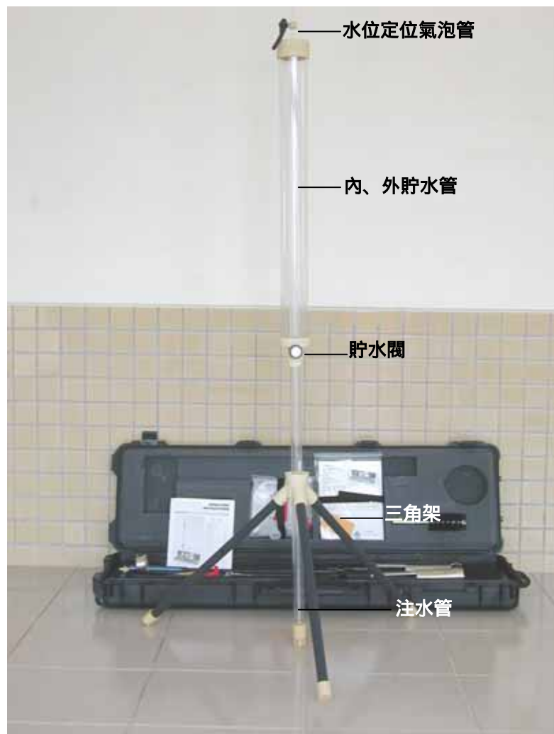
圖 5-3 葛洛夫滲透儀之基本構造
