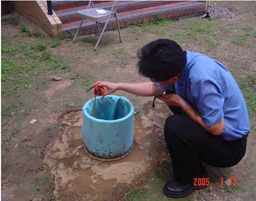
圖 5-19 試驗滲透陰井水位量測圖 (1)
