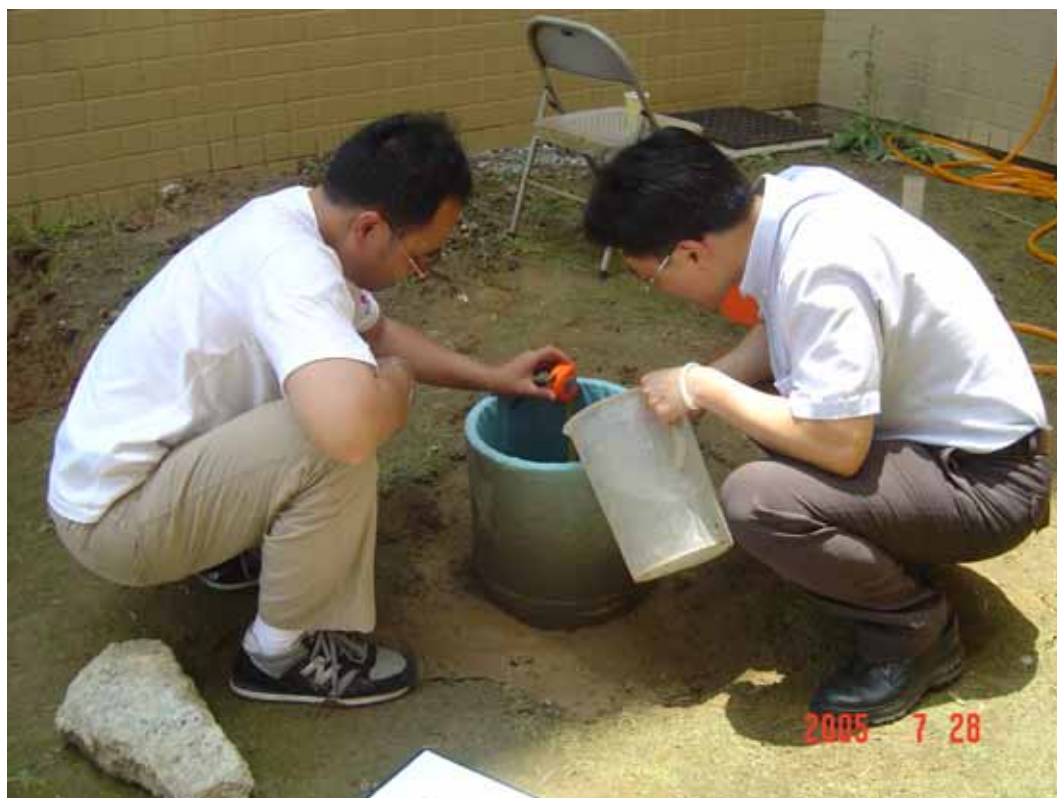
圖 5-21 試驗滲透陰井人工加水示意圖 (1)
