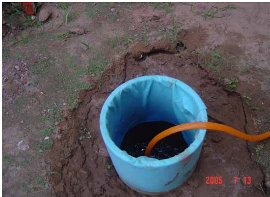
圖 5-18 試驗滲透陰井加水示意圖
