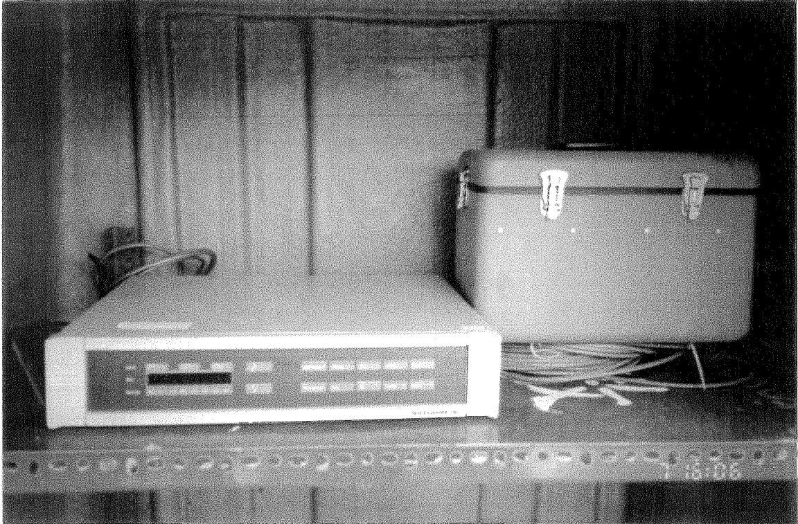
圖5-7 數據機<左>及數位處理器<右> (設置於圖5-5測站之上層)
